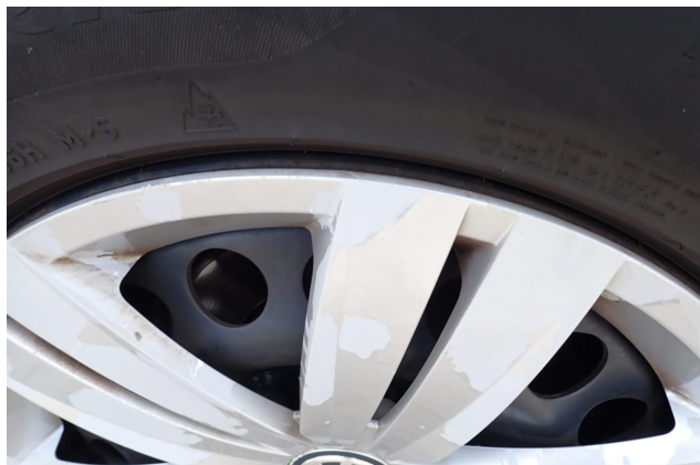
Beschädigung 1: 2.Radsatz: Radblendensatz komplett - Abrieb - erneuern
