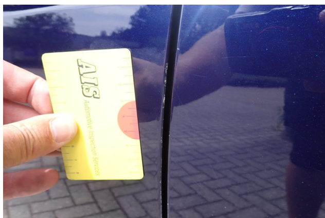
Gebrauchsspur 3: Tür vorn links: Tür - Kratzer - kein Abzug
