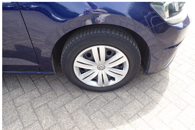
Beschädigung 1: 2.Radsatz: Radblendensatz komplett - Abrieb - erneuern
