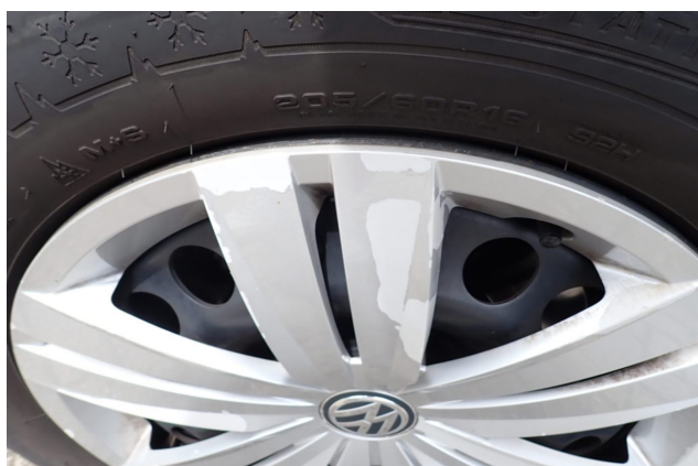
Beschädigung 1: 2.Radsatz: Radblendensatz komplett - Abrieb - erneuern
