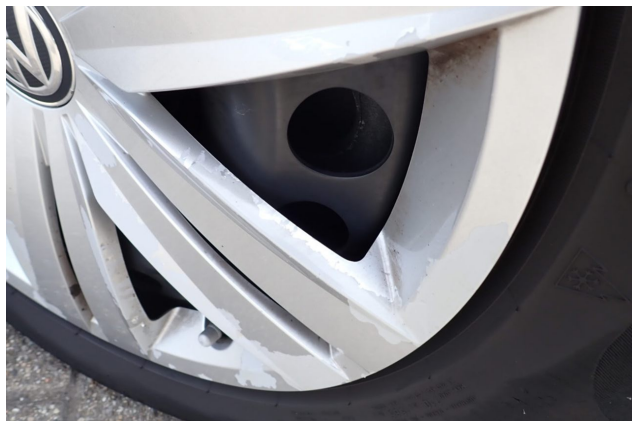
Beschädigung 1: 2.Radsatz: Radblendensatz komplett - Abrieb - erneuern
