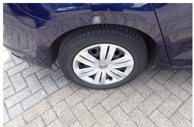
Beschädigung 1: 2.Radsatz: Radblendensatz komplett - Abrieb - erneuern
