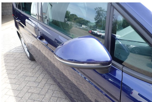
Beschädigung 8: Außenspiegel rechts: Abdeckkappe - verkratzt / verschürft - lackieren
