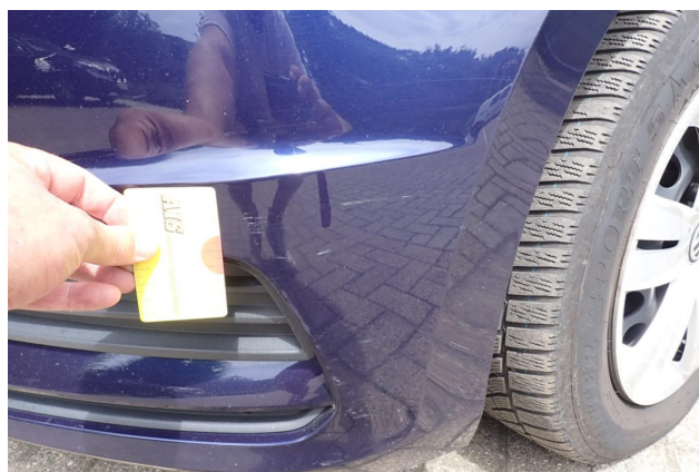
Beschädigung 14: Stossfänger vorn: Stossfänger vorn - verkratzt / verschürft - instandsetzen und lackieren
