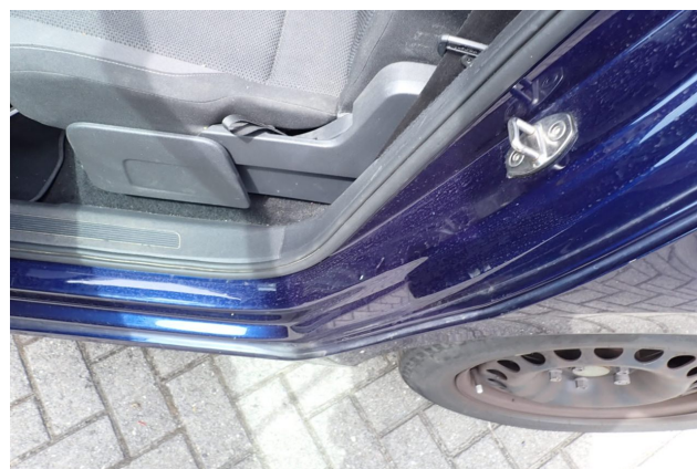
Gebrauchsspur 4: Seitenwand links: Einstieg - Delle / Lackschaden - kein Abzug
