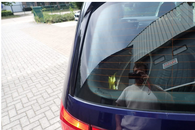
Beschädigung 15: Verglasung: Heckscheibe - Kratzer - erneuern
