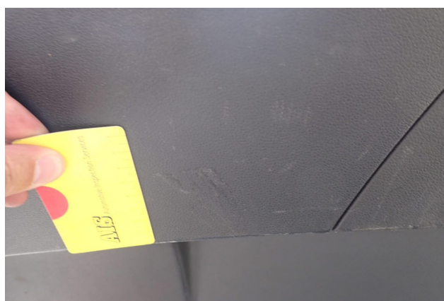
Beschädigung 10: Verkleidungen/Abdeckungen: Heckdeckel, Innenverkleidung - Kratzer - Smart Repair
