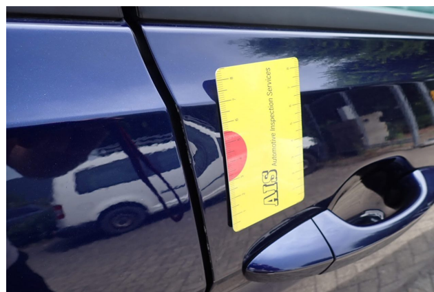
Beschädigung 6: Tür vorn rechts: Tür - Delle / Lackschaden - kein Abzug
