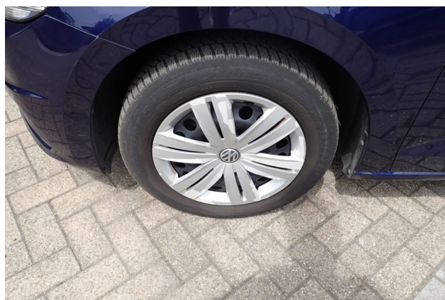
Beschädigung 1: 2.Radsatz: Radblendensatz komplett - Abrieb - erneuern
