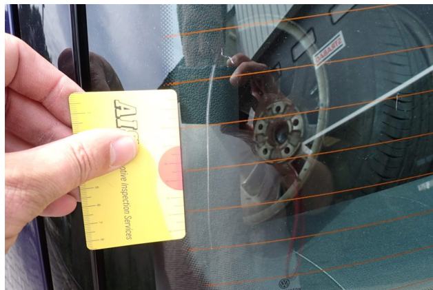
Beschädigung 15: Verglasung: Heckscheibe - Kratzer - erneuern
