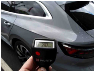
Lackstärke Seitenwand hinten links
