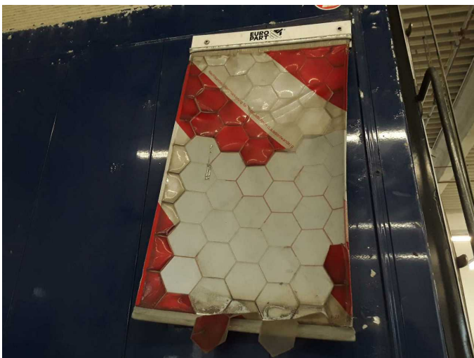
Damage 1: Misc.: Misc. (2x Warnwimpel) - Broken / torn - Replace
