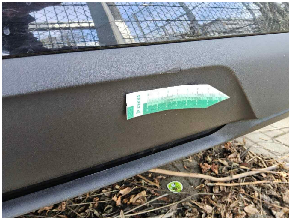
Bild 12 : Stoßfänger hinten, zerkratzt/gekerbt
