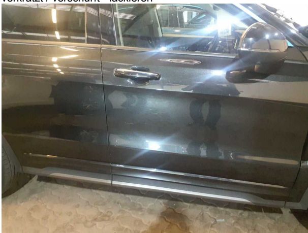
Beschädigung #4: Tür vorn rechts: Tür - Kratzer - lackieren
