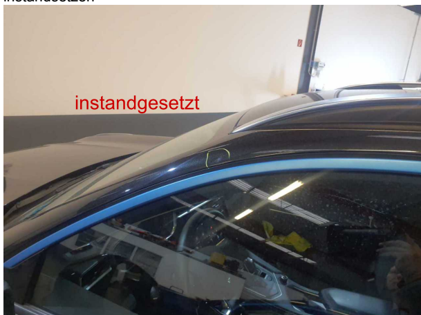
Beschädigung #2: Fahrzeugdach: Dachholm links - Delle(n) - sanft instandsetzen
