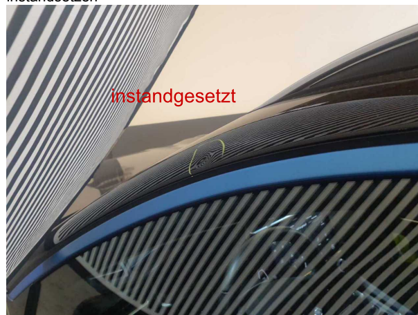
Beschädigung #2: Fahrzeugdach: Dachholm links - Delle(n) - sanft instandsetzen
