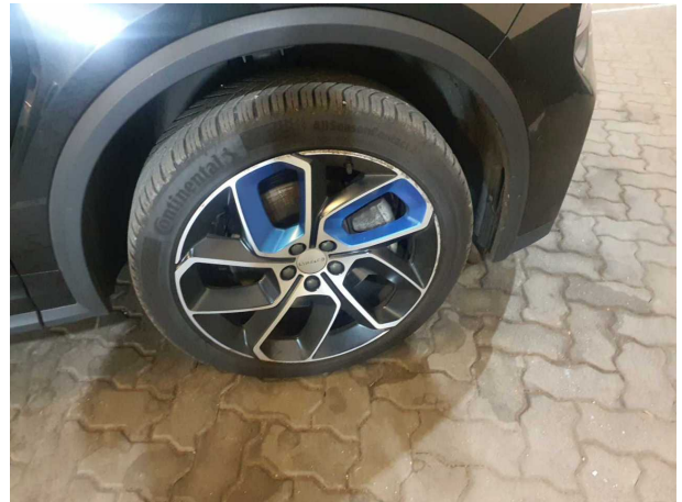
Beschädigung #6: Rad/Reifen: Leichtmetallfelge vorn rechts - verkratzt / verschürft - erneuern
