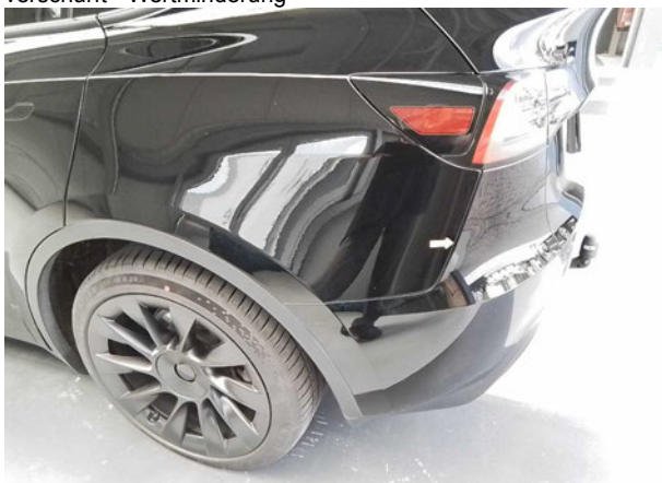
Beschädigung #2: Stossfänger hinten: Stossfänger hinten - Fehlstellung - befunden ggf. instandsetzen
