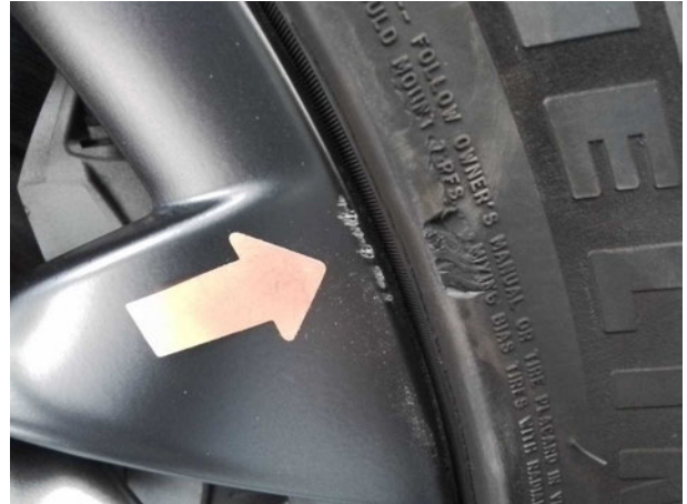
Beschädigung #1: Rad/Reifen: Leichtmetallfelge vorn links - verkratzt / verschürft - Wertminderung
