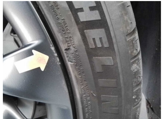
Beschädigung #4: Rad/Reifen: Reifen vorn links - beschädigt - erneuern
