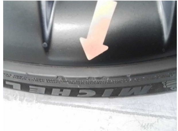
Beschädigung #3: Rad/Reifen: Reifen hinten rechts - beschädigt - erneuern
