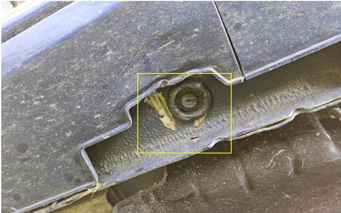
Bild 15 : Seitenschweller rechts Lackierung, gerissen, lackieren mit Lackaufbau
