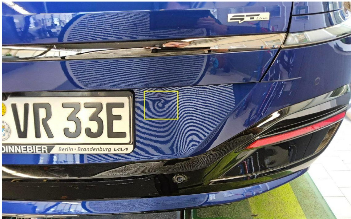
Bild 9 : Stoßfänger hinten, eingedellt, instandsetzen und lackieren mit Lackaufbau
