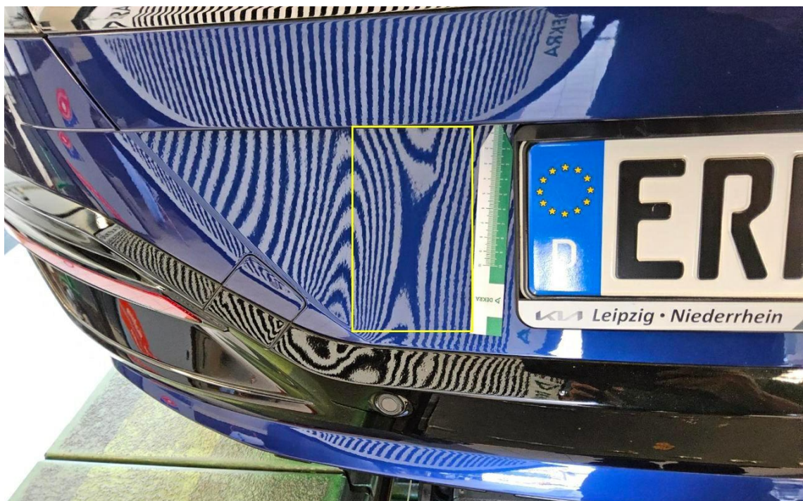
Bild 10 : Stoßfänger hinten, eingedellt, instandsetzen und lackieren mit Lackaufbau
