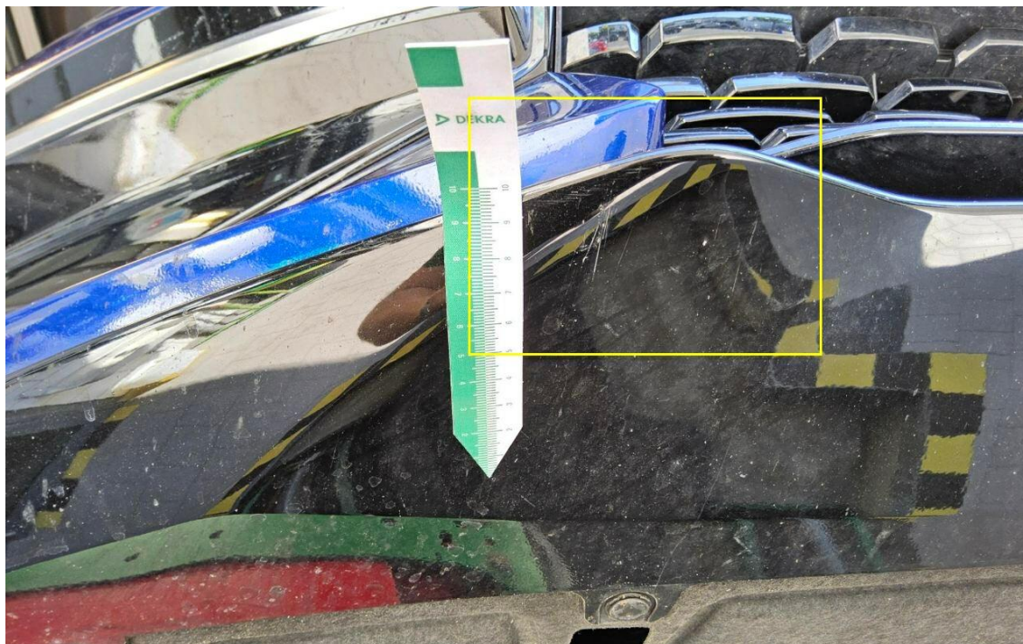
Bild 13 : Frontspoiler Lackierung, zerkratzt, lackieren
