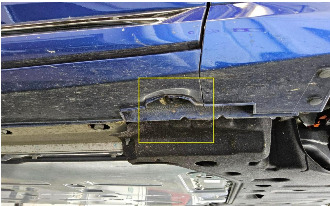
Bild 16 : Seitenschwellerverkleidung rechts deformiert
