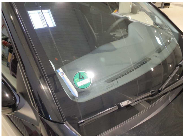
Beschädigung #1: Verglasung: Frontscheibe (Mit Rissbildung) - Steinschlag - erneuern
