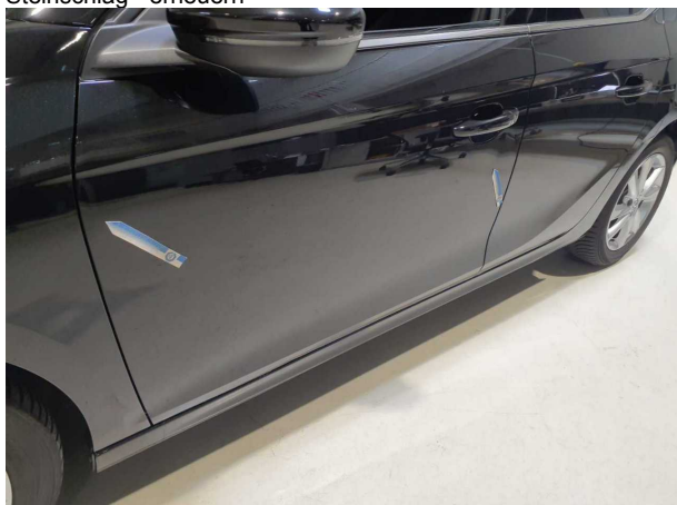
Beschädigung #2: Tür vorn links: Tür - Delle / Lackschaden - instandsetzen und lackieren
