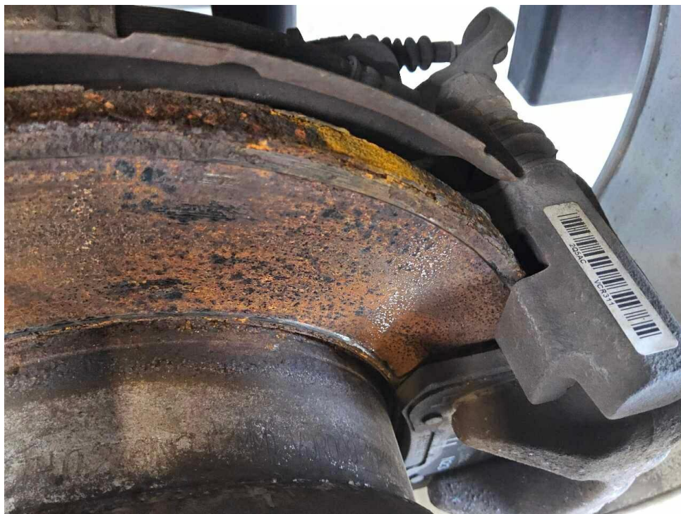
Bild 23 : Bremsscheiben Hinterachse Tragbild mangelhaft, Riefen-und Korrosionsbildung
