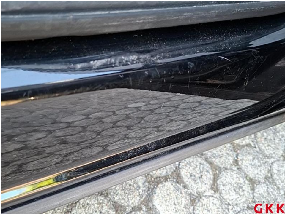
Bild 29. Tür hinten rechts, Einstieg, verkratzt, Smartrepair
