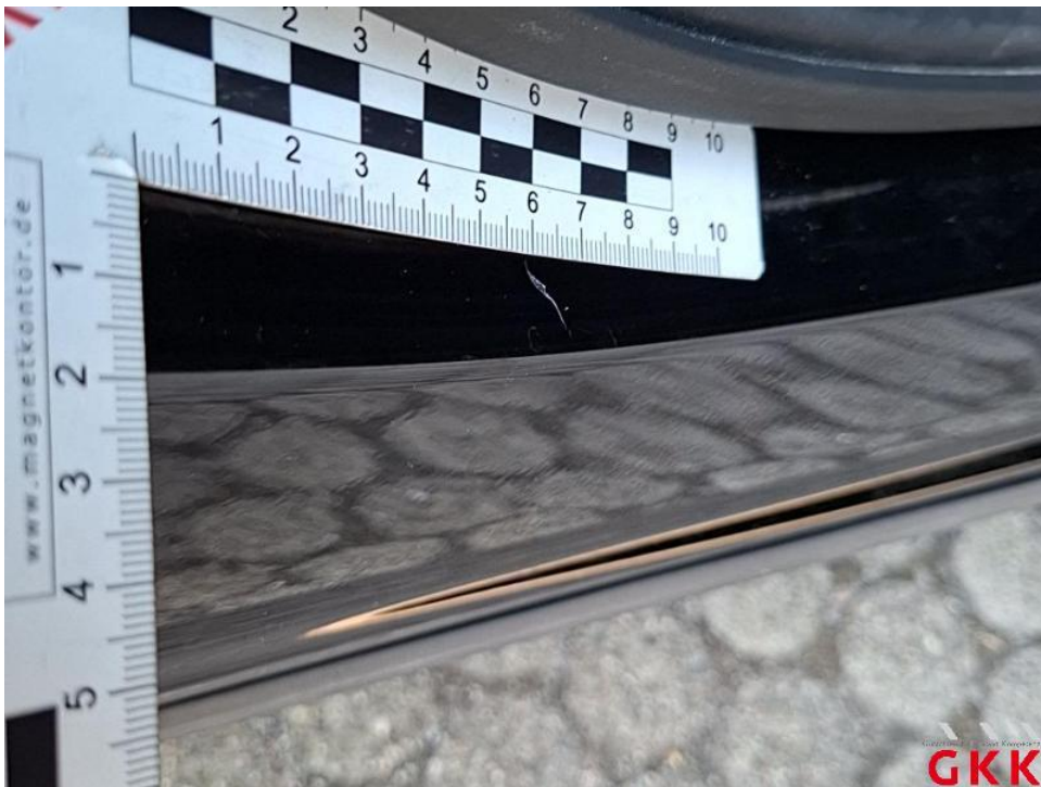
Bild 28. Tür hinten rechts, Einstieg, verkratzt, Smartrepair
