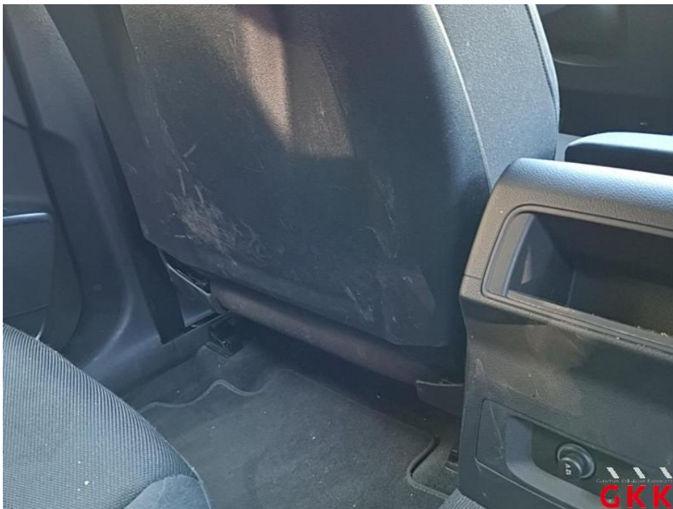
Bild 44. Sitz vorne links, Verkleidung, verkratzt, ersetzen
