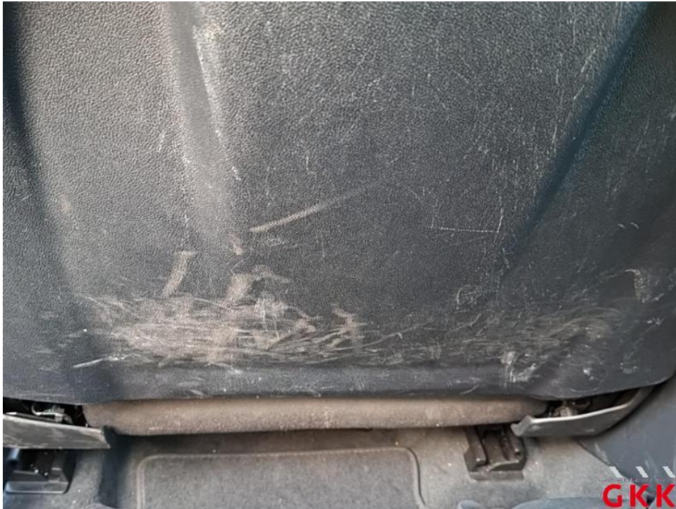
Bild 45. Sitz vorne links, Verkleidung, verkratzt, ersetzen
