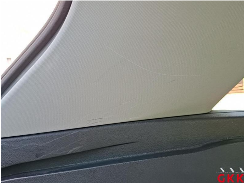
Bild 47. D- Säule links, Innenverkleidung, verkratzt, ersetzen
