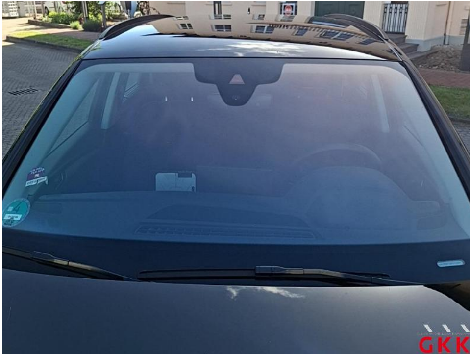
Bild 19. Frontscheibe, wärmedämmend mit Regensensor und Frontkamera, Steinschlag mit Rissbildung, ersetzen
