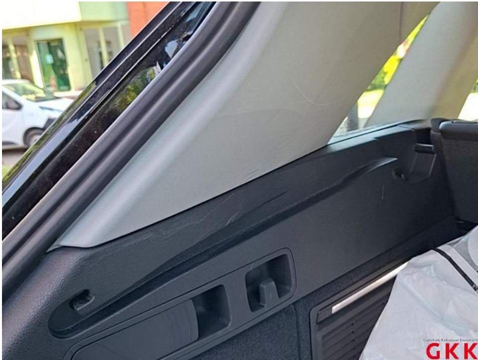
Bild 48. Seitenwand links, Innenverkleidung, verkratzt, ersetzen
