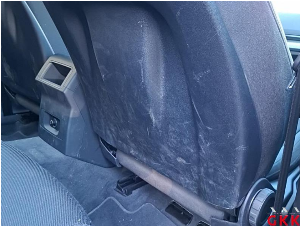
Bild 42. Sitz vorne rechts, Verkleidung, verkratzt, ersetzen
