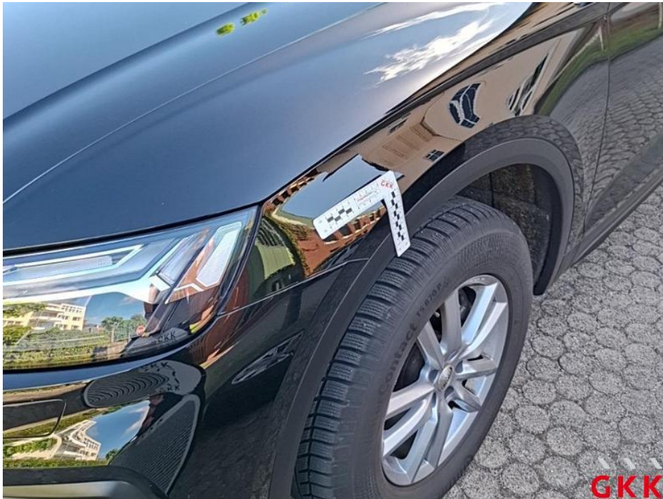
Bild 16. Kotflügel vorne links, beschädigt, instand setzen - lackieren
