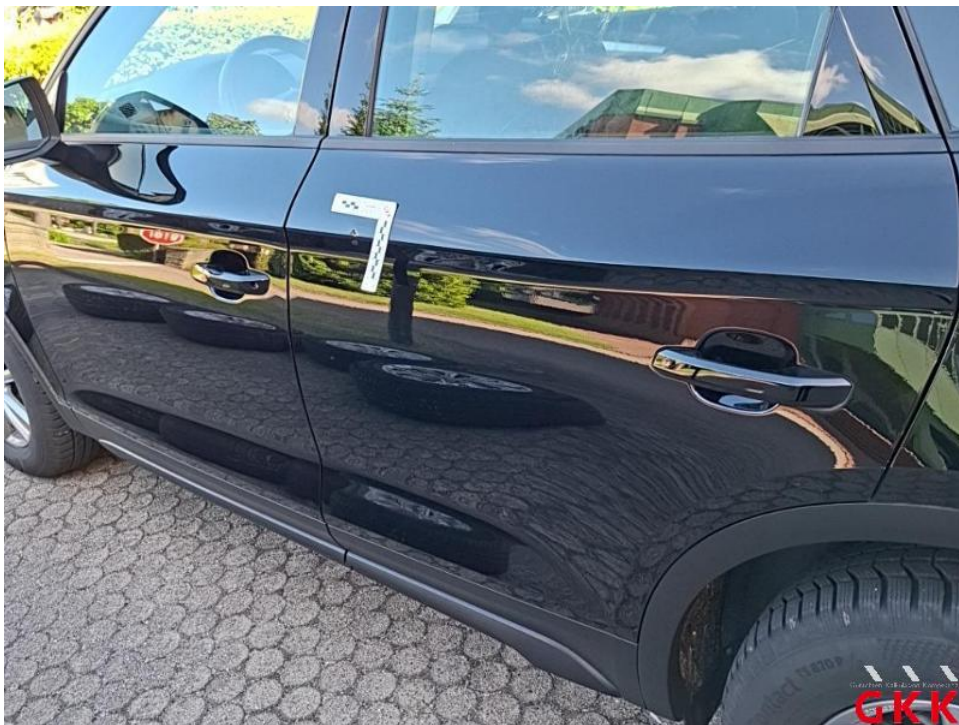
Bild 36. Tür hinten links, beschädigt, instand setzen - lackieren
