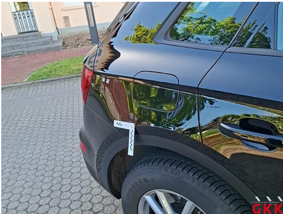
Bild 30. Seitenwand rechts, verkratzt, lackieren
