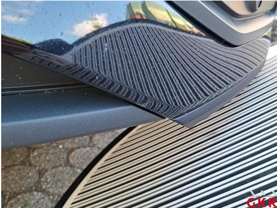
Bild 21. vorne links unten Stoßfänger vorne, Verkleidung -lackiert-, beschädigt, instand setzen - lackieren
