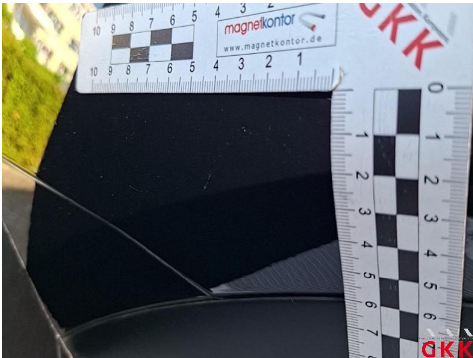
Bild 18. Kotflügel vorne links, beschädigt, instand setzen - lackieren
