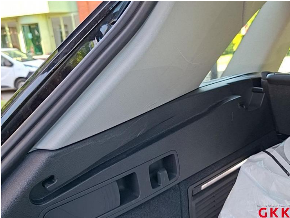
Bild 46. D- Säule links, Innenverkleidung, verkratzt, ersetzen
