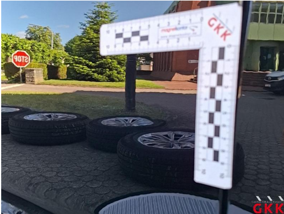
Bild 41. Tür vorne links, bis 3 Dellen / Bauteil, kalt drücken
