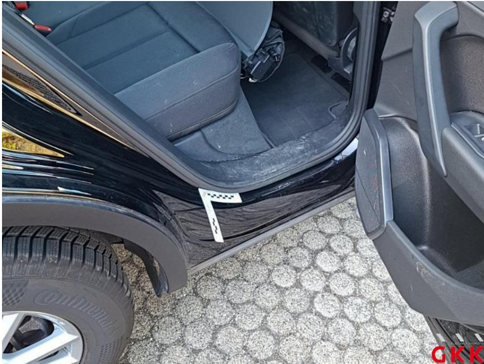
Bild 27. Tür hinten rechts, Einstieg, verkratzt, Smartrepair
