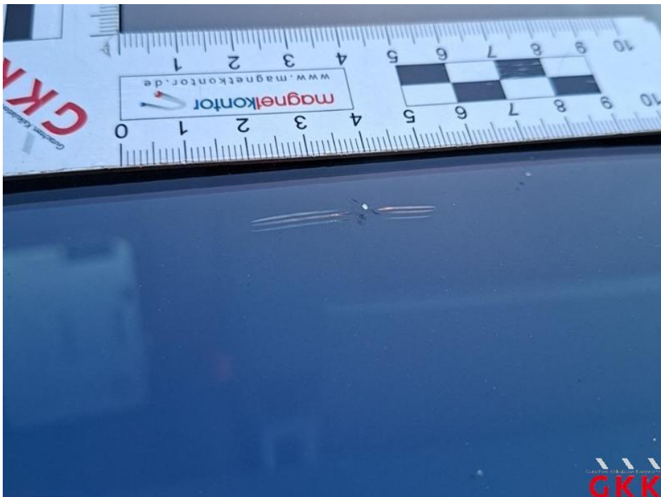
Bild 20. Frontscheibe, wärmedämmend mit Regensensor und Frontkamera, Steinschlag mit Rissbildung, ersetzen
