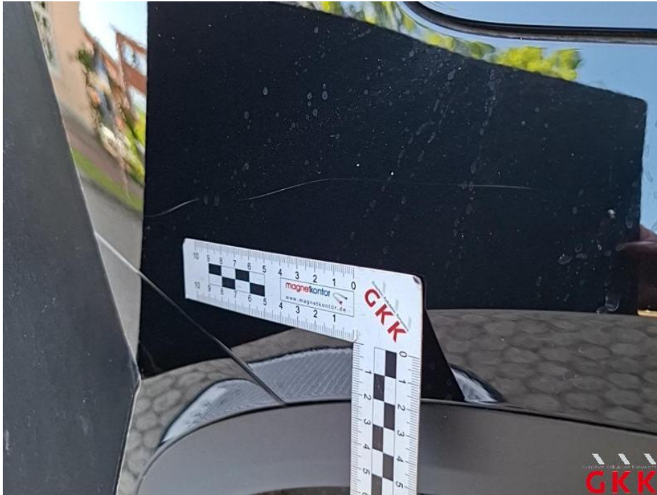
Bild 31. Seitenwand rechts, verkratzt, lackieren
