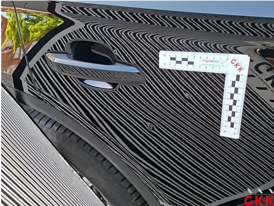
Bild 25. Tür hinten rechts, beschädigt, instand setzen - lackieren
