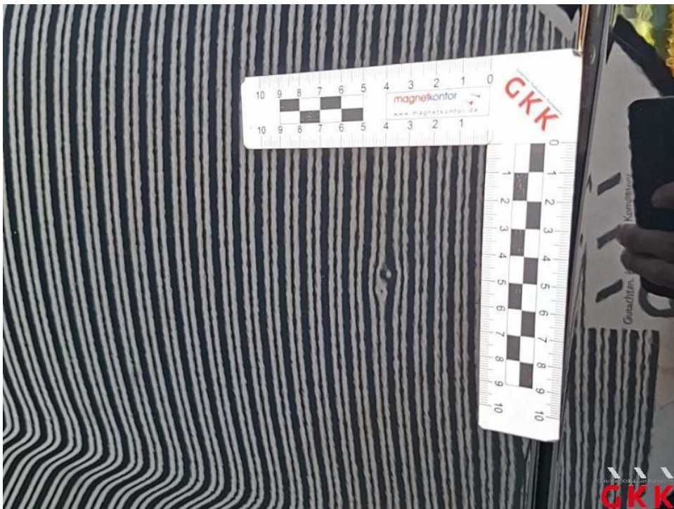
Bild 40. Tür vorne links, bis 3 Dellen / Bauteil, kalt drücken
