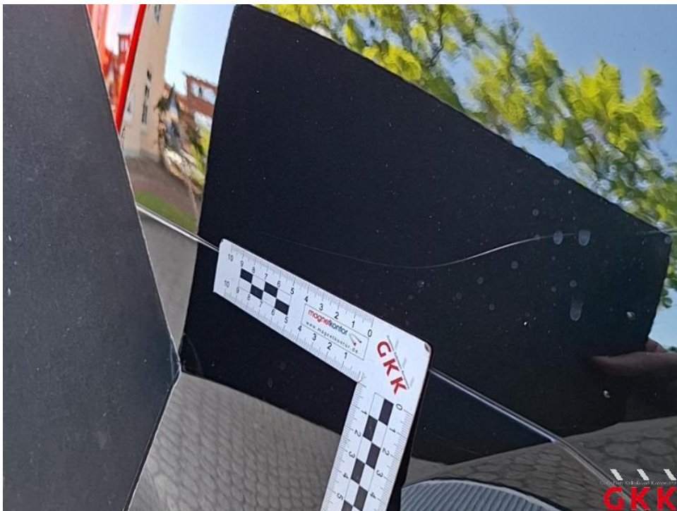
Bild 32. Seitenwand rechts, verkratzt, lackieren
