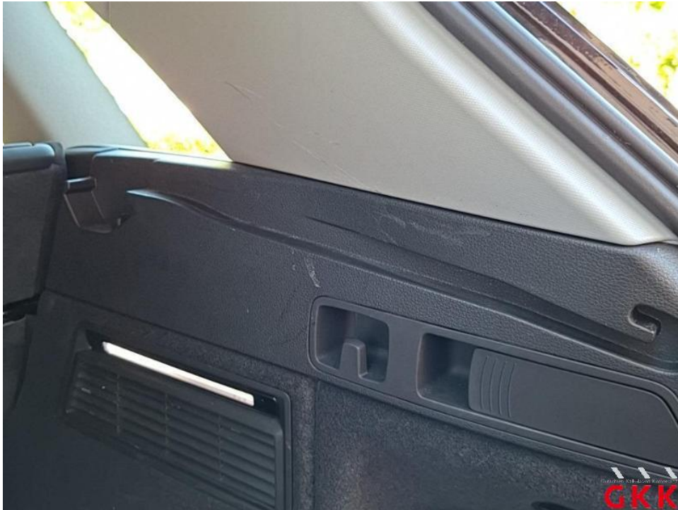
Bild 49. D- Säule rechts, Innenverkleidung, verkratzt, ersetzen
