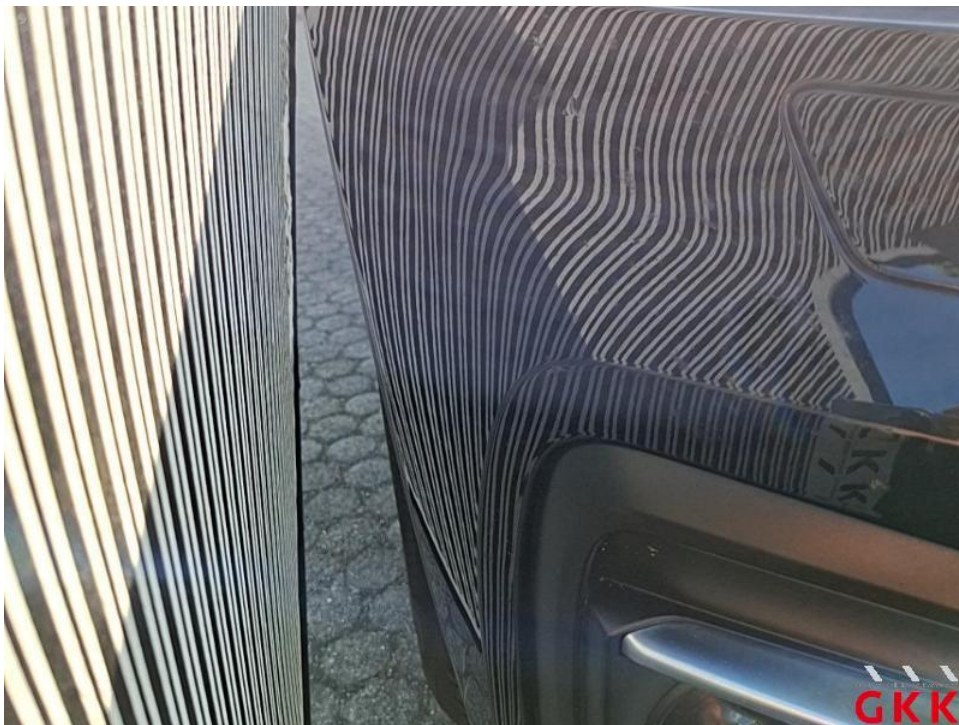
Bild 22. vorne rechts oben Stoßfänger vorne, Verkleidung -lackiert-, beschädigt, instand setzen - lackieren
