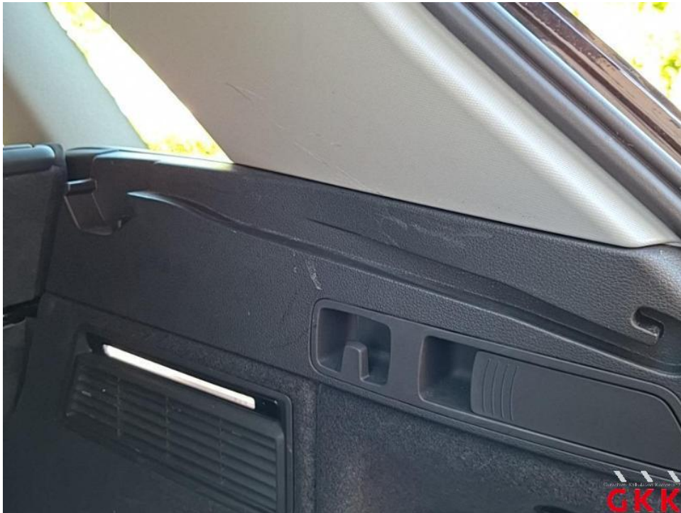
Bild 50. Seitenwand rechts, Innenverkleidung, verkratzt, ersetzen
