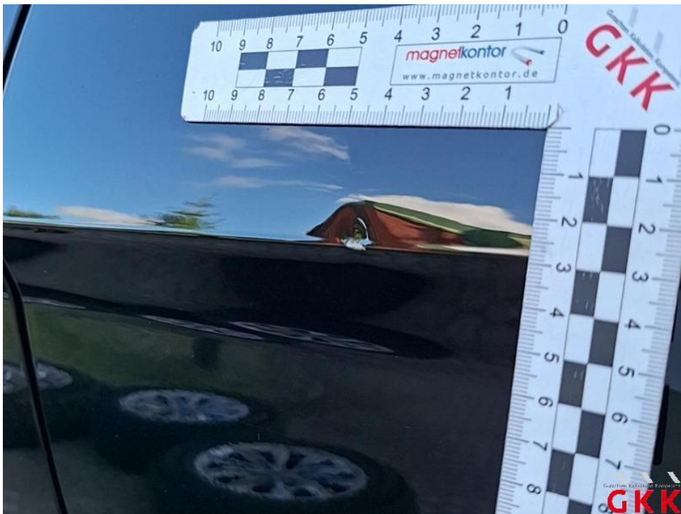
Bild 38. Tür hinten links, beschädigt, instand setzen - lackieren
