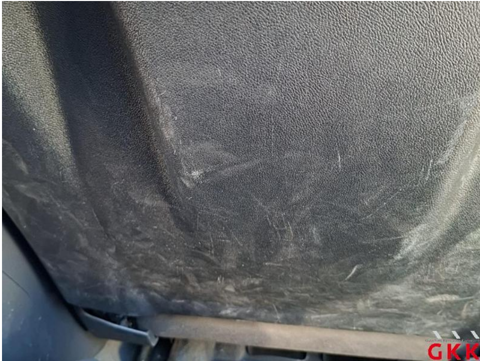
Bild 43. Sitz vorne rechts, Verkleidung, verkratzt, ersetzen
