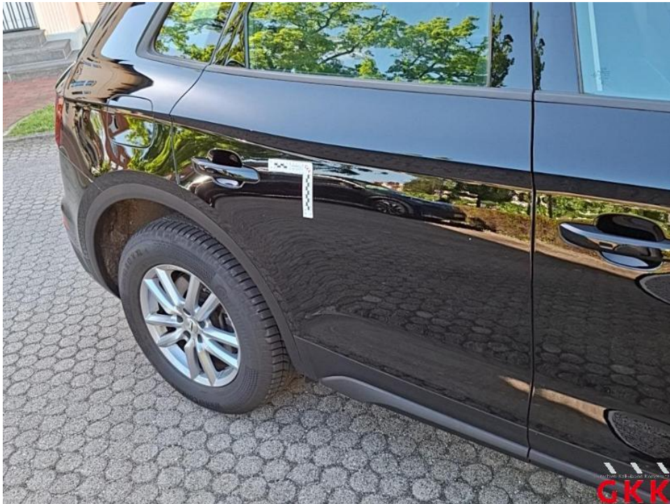
Bild 24. Tür hinten rechts, beschädigt, instand setzen - lackieren
