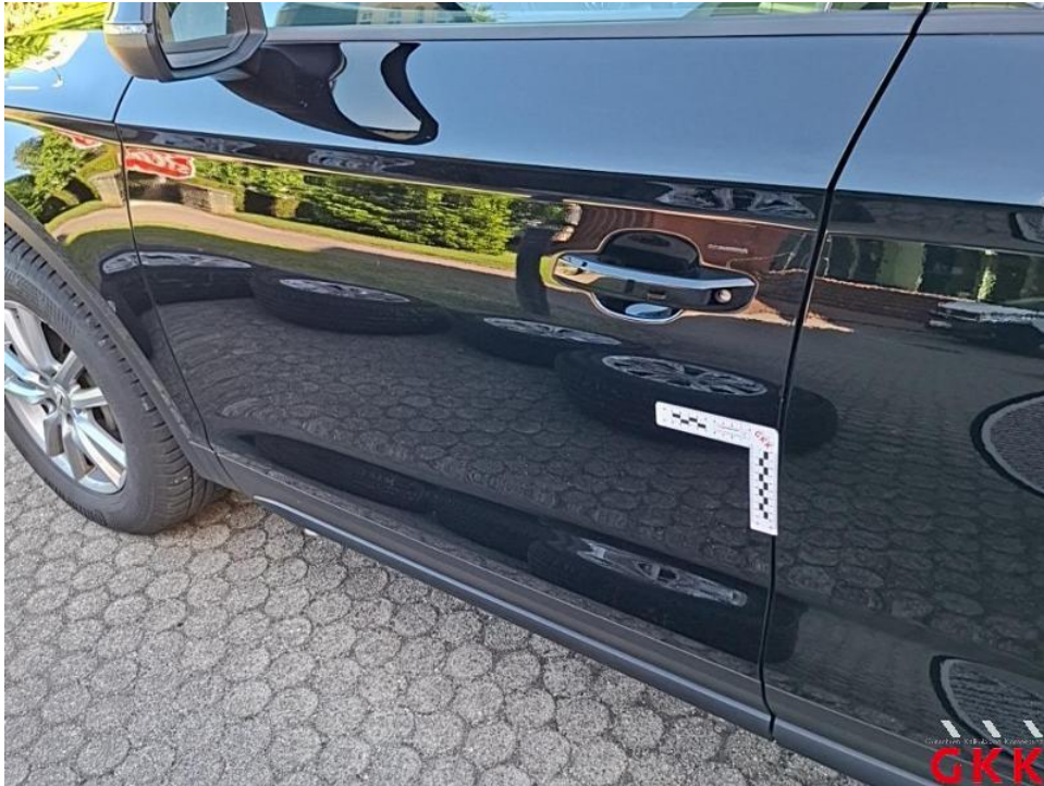
Bild 39. Tür vorne links, bis 3 Dellen / Bauteil, kalt drücken
