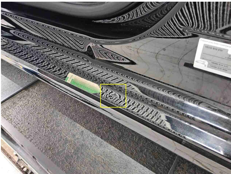
Bild 18 : Einstiegsschweller vorne links eingedellt
