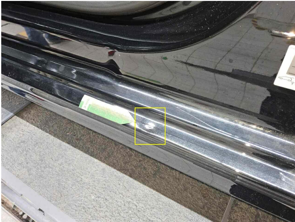
Bild 17 : Einstiegsschweller vorne links eingedellt
