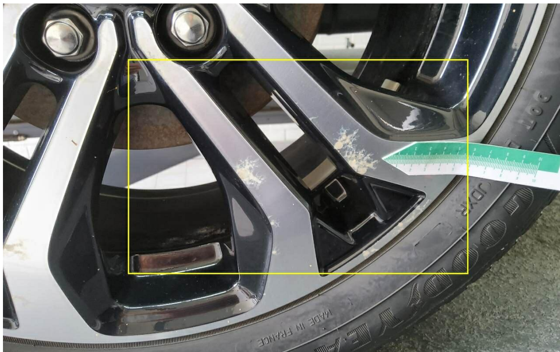
Bild 43 : Leichtmetallrad hinten links mehrfach Korossionsunterwandert
