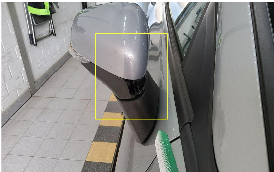
Bild 54 : Außenspiegel rechts Gehäuse gebrochen
