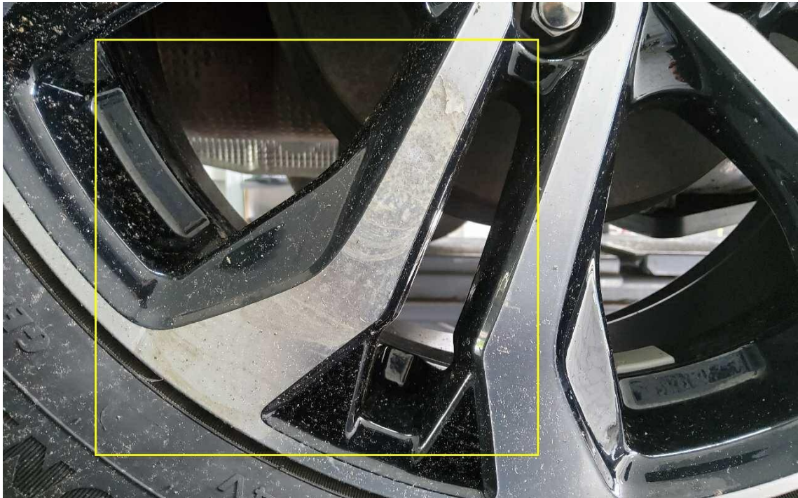
Bild 47 : Leichtmetallrad hinten rechts mehrfach Korossionsunterwandert
