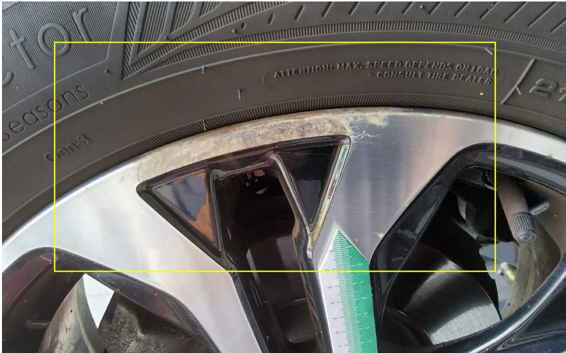
Bild 39 : Leichtmetallrad vorne links mehrfach Korossionsunterwandert
