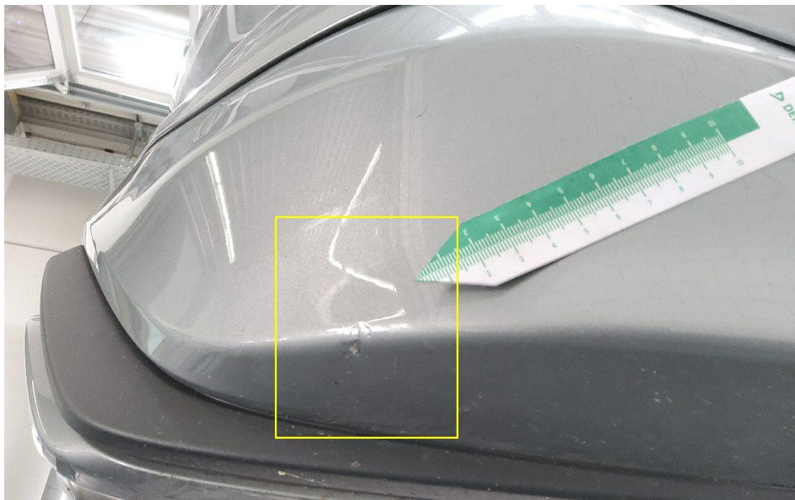
Bild 51 : Stoßfängerverkleidung hinten unterhalb leichte Kratzer und Druckstelle
