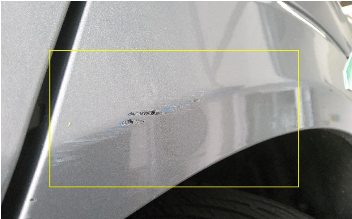
Bild 21 : Radzierblende Seitenwand hinten links verschrammt
