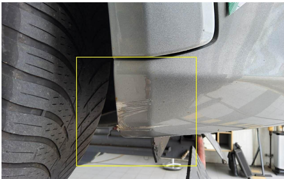
Bild 32 : Stoßfängerverkleidung vorne Spoiler mehrfach verschrammt
