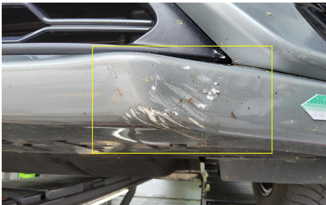
Bild 34 : Stoßfängerverkleidung vorne Spoiler mehrfach verschrammt
