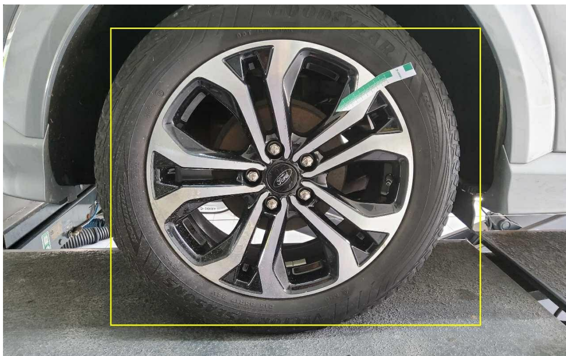
Bild 44 : Leichtmetallrad hinten rechts mehrfach Korossionsunterwandert
