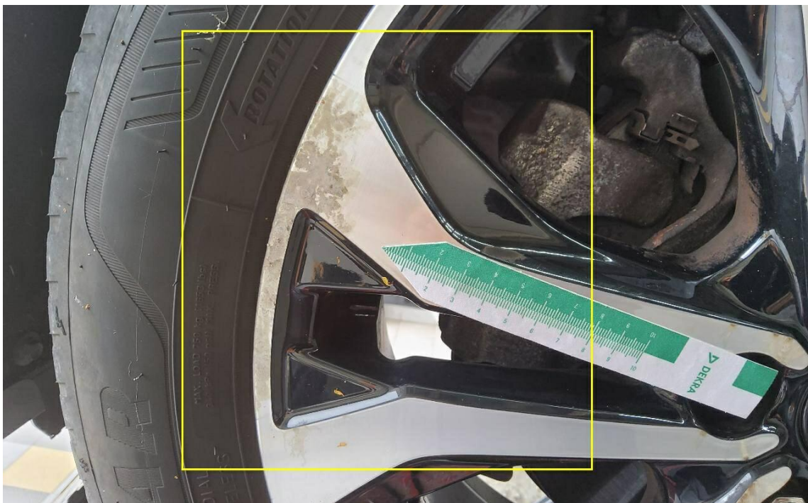
Bild 38 : Leichtmetallrad vorne links mehrfach Korossionsunterwandert
