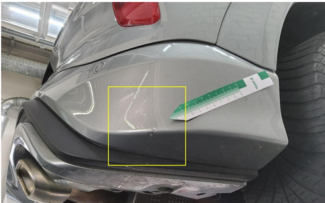
Bild 50 : Stoßfängerverkleidung hinten unterhalb leichte Kratzer und Druckstelle
