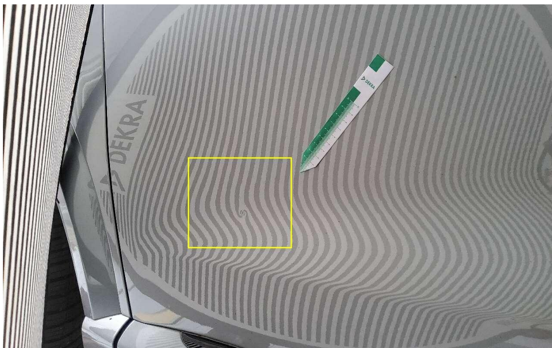
Bild 16 : Tür vorne links mehrere Dellen mit Lackbeschädigung, Drücken und Auslegen + Polieren
