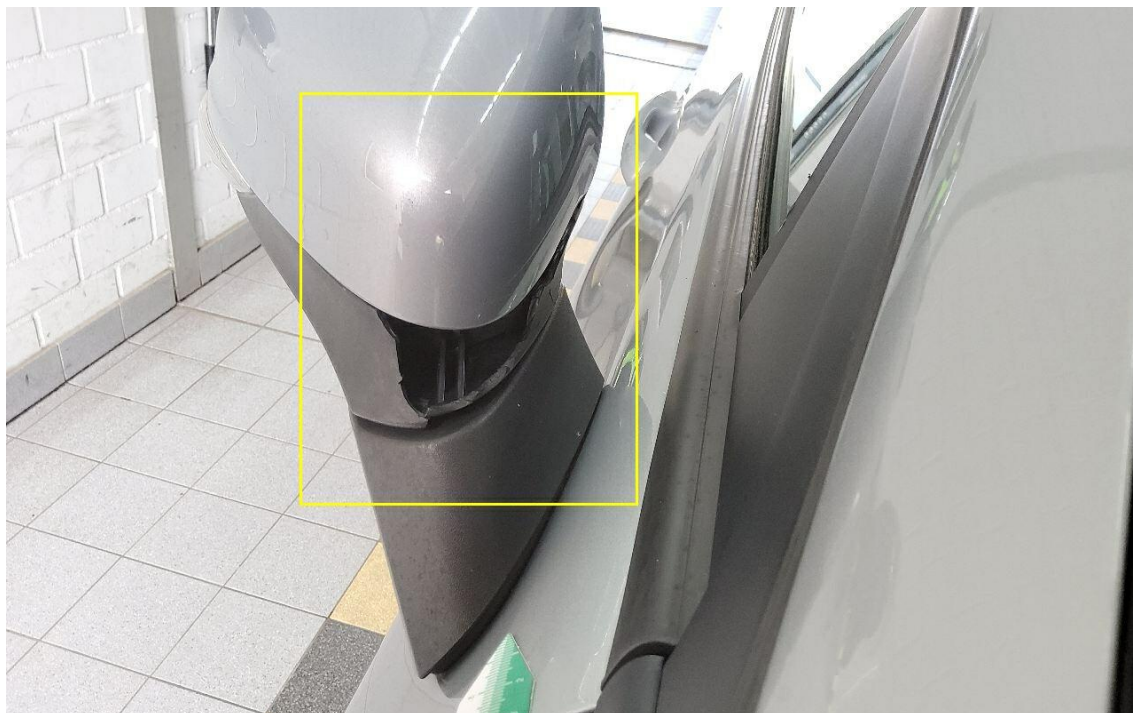
Bild 55 : Außenspiegel rechts Gehäuse gebrochen
