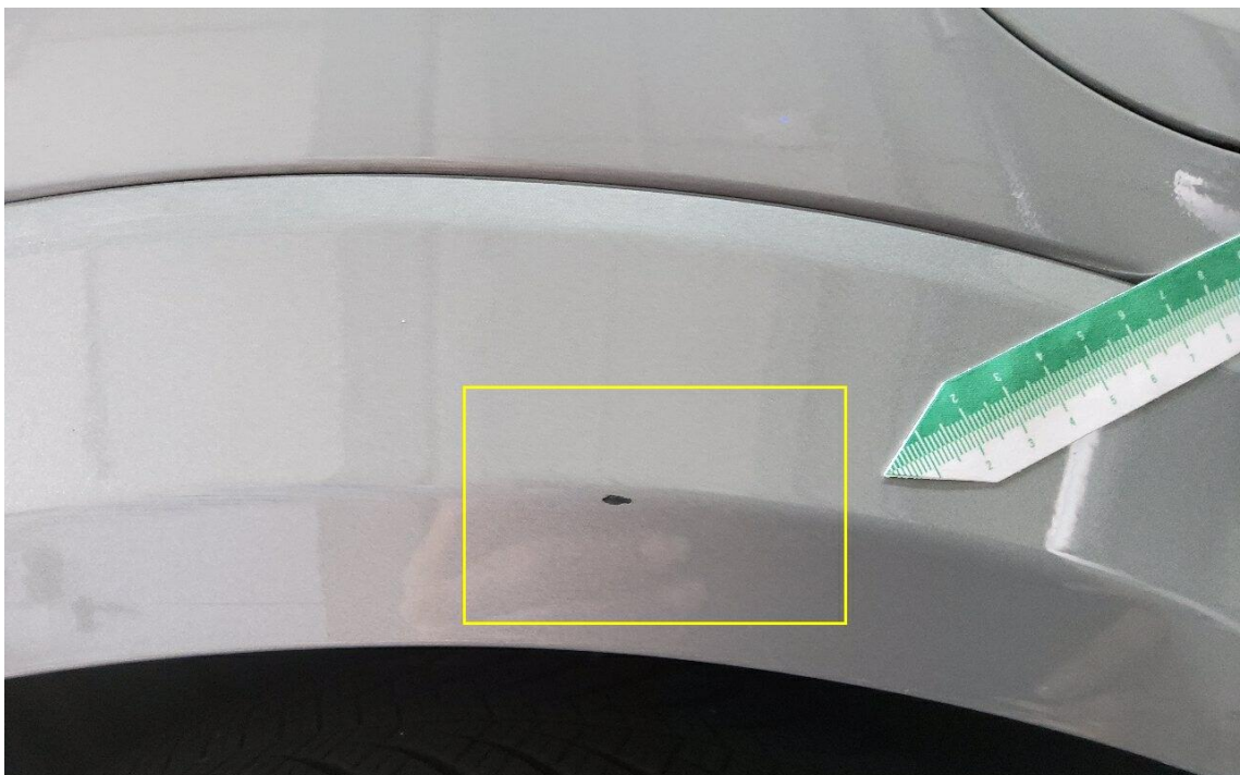
Bild 22 : Radzierblende Seitenwand hinten links verschrammt
