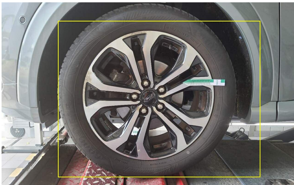
Bild 36 : Leichtmetallrad vorne links mehrfach Korossionsunterwandert
