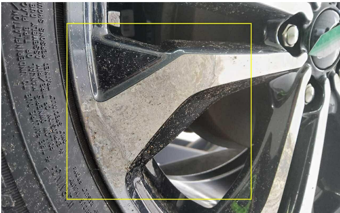
Bild 46 : Leichtmetallrad hinten rechts mehrfach Korossionsunterwandert
