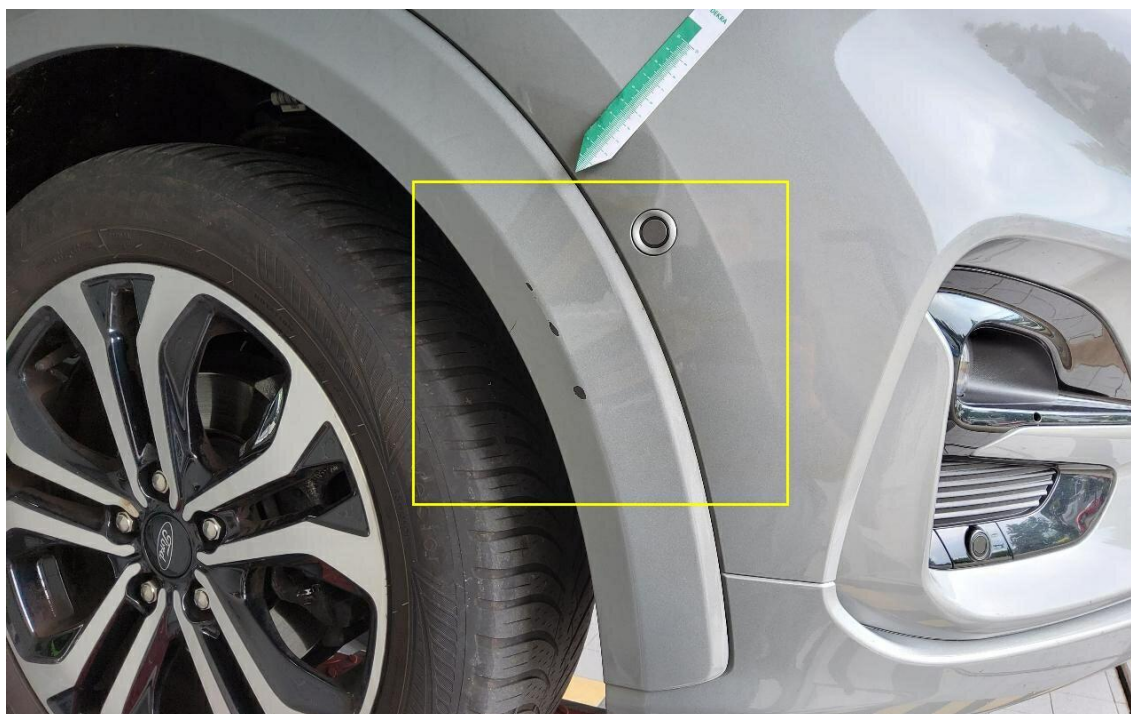
Bild 26 : Radlaufverbreiterung vorne rechts gebrochen
