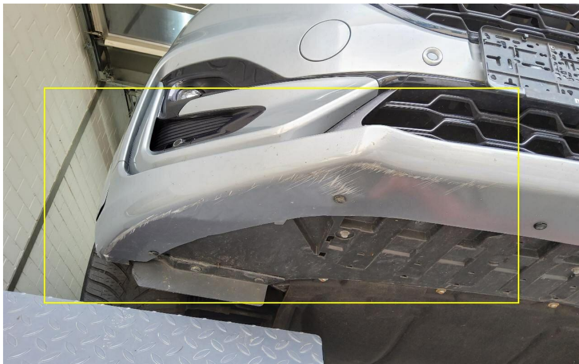
Bild 35 : Stoßfängerverkleidung vorne Spoiler mehrfach verschrammt
