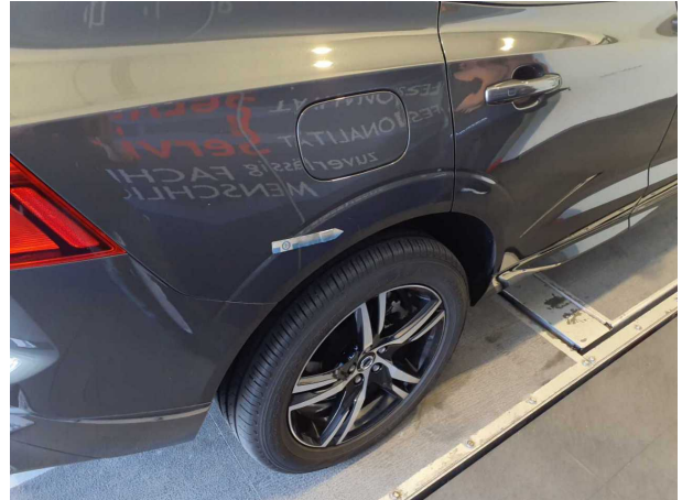
Beschädigung #2: Seitenwand rechts: Seitenwand - Kratzer - Smart Repair
