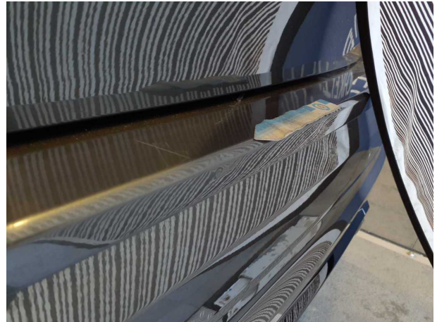
Beschädigung #4: Stossfänger hinten: Stossfänger hinten - Delle / Lackschaden - instandsetzen und lackieren
