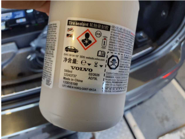
Beschädigung #1: Ausrüstung: Tirefit Füllmittel - abgelaufen - erneuern
