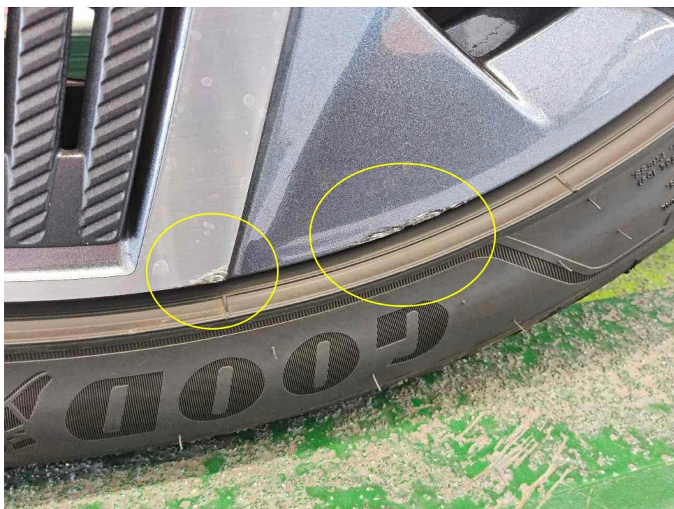
Bild 16 : Felge hinten rechts verschrammt (Glanzgedreht)
