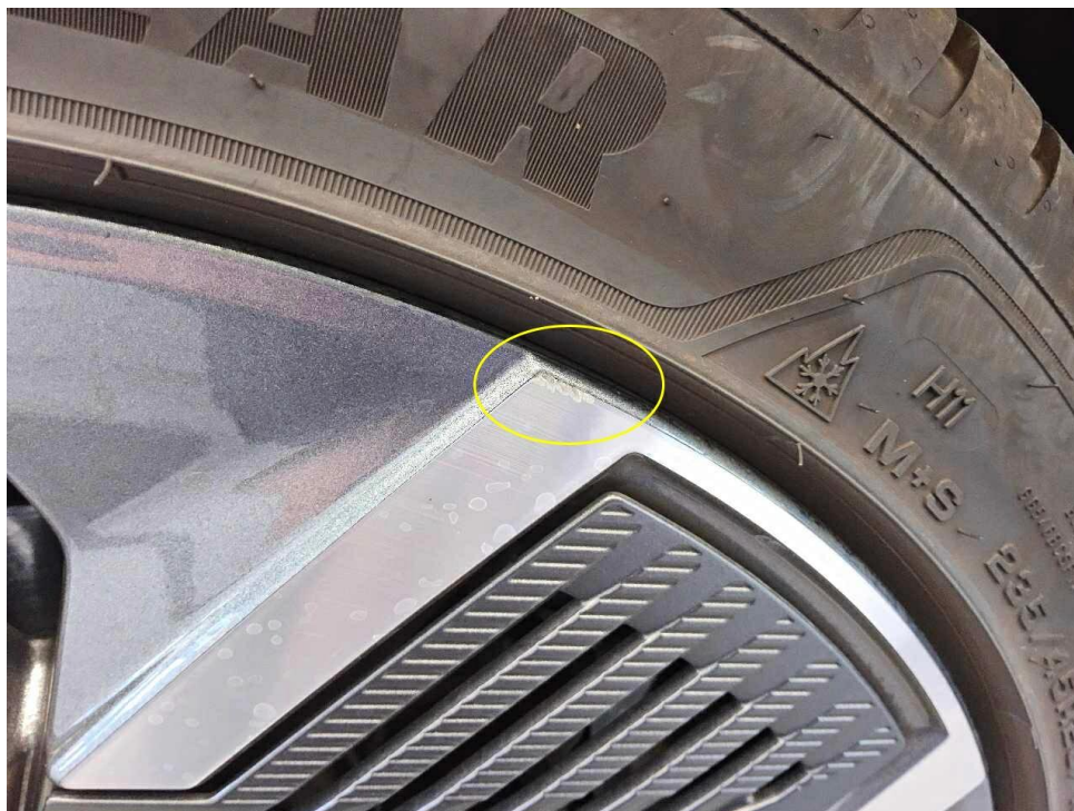
Bild 15 : Felge hinten rechts verschrammt (Glanzgedreht)
