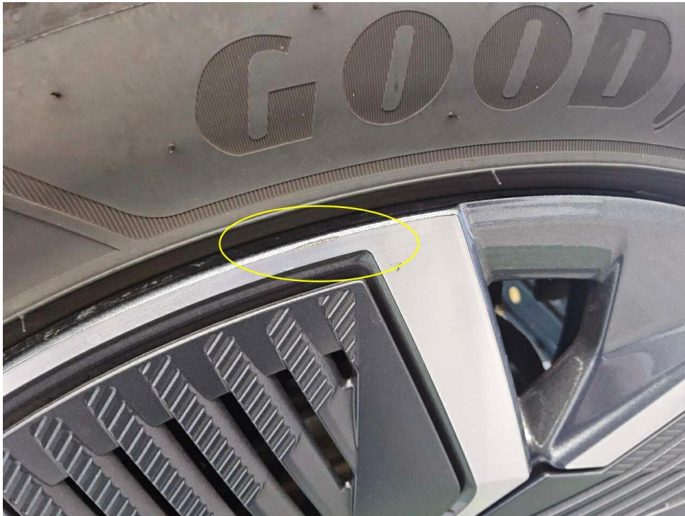
Bild 17 : Felge hinten links verschrammt (Glanzgedreht)
