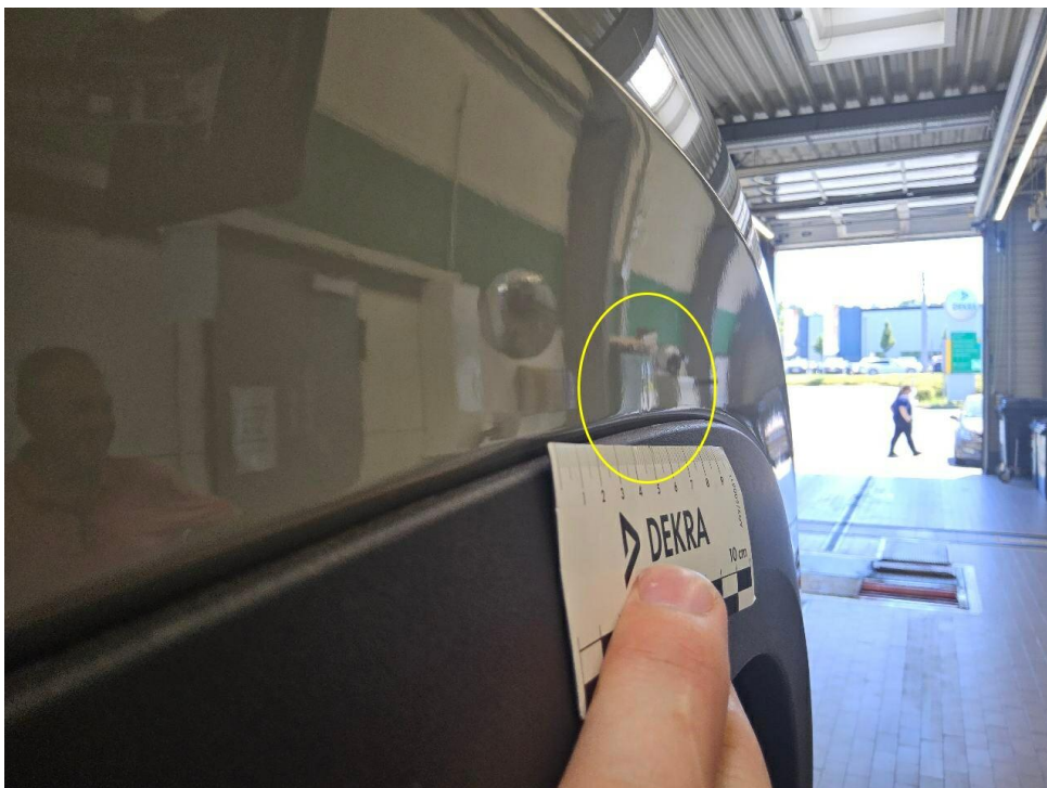
Bild 18 : Restspuren Reparaturlackierung Seitenwand hinten links
