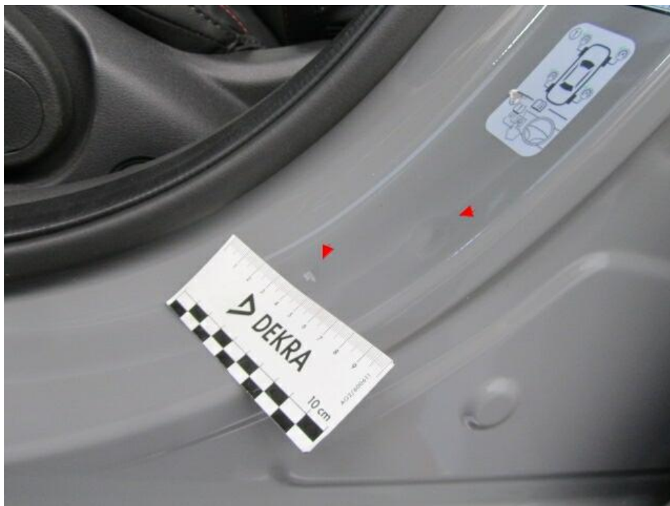
Bild 21 : Tür vorne links Einstieg Dellen Kratzer, Türrahmen eingedellt
