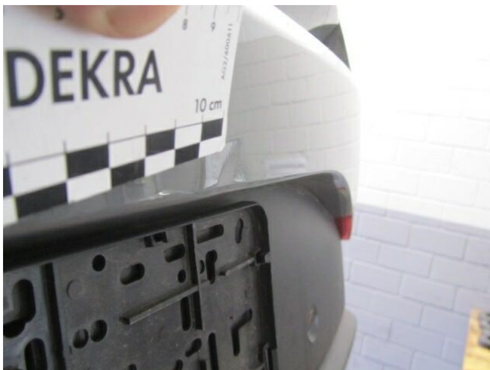
Bild 24 : Stoßfänger hinten, mehrfach eingedellt, instandsetzen und lackieren mit Lackaufbau
