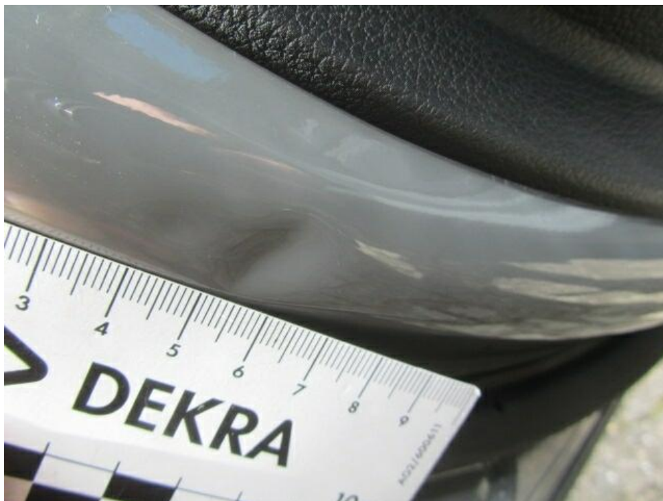
Bild 27 : Tür vorne links Einstieg, Türrahmen eingedellt
