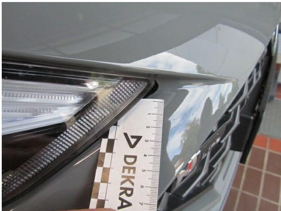
Bild 18 : Kaskoschaden vorne rechts Stossfänger verschrammt, eingekerbt,
