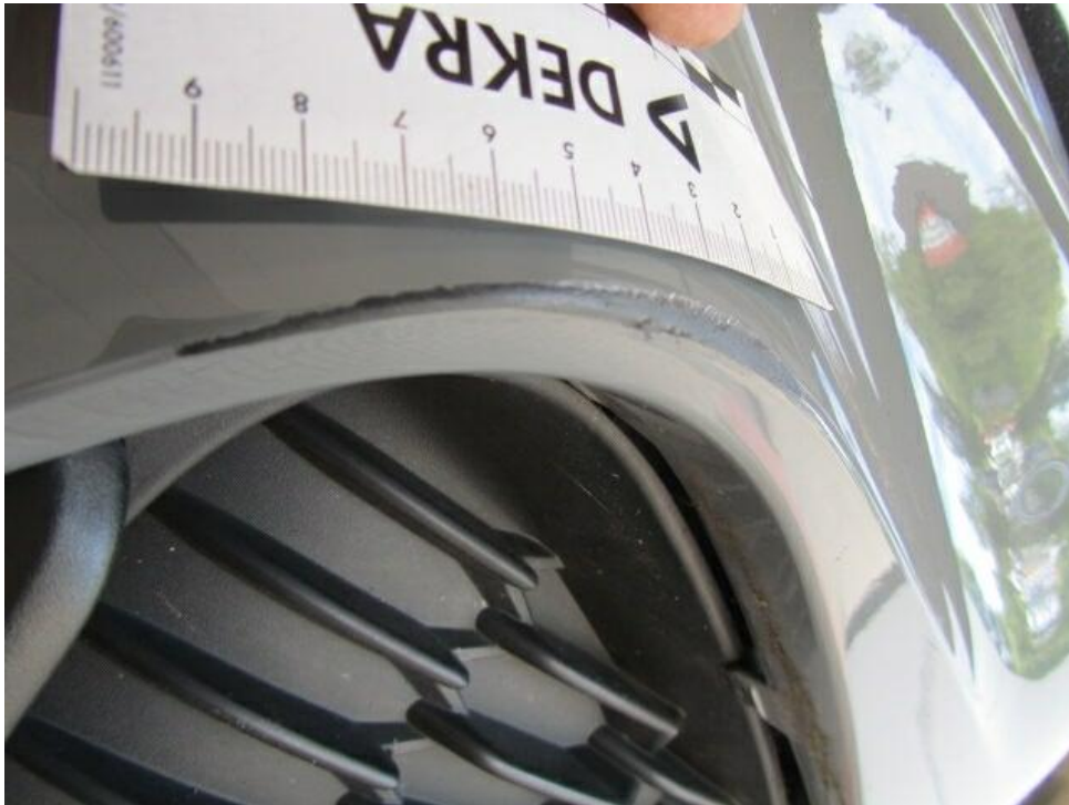
Bild 15 : Kaskoschaden vorne rechts Stossfänger verschrammt, eingekerbt, Scheinwerfer verschrammt erneuern
