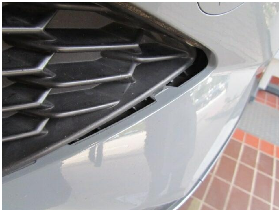
Bild 19 : Kaskoschaden vorne rechts Stossfänger verschrammt, eingekerbt,
