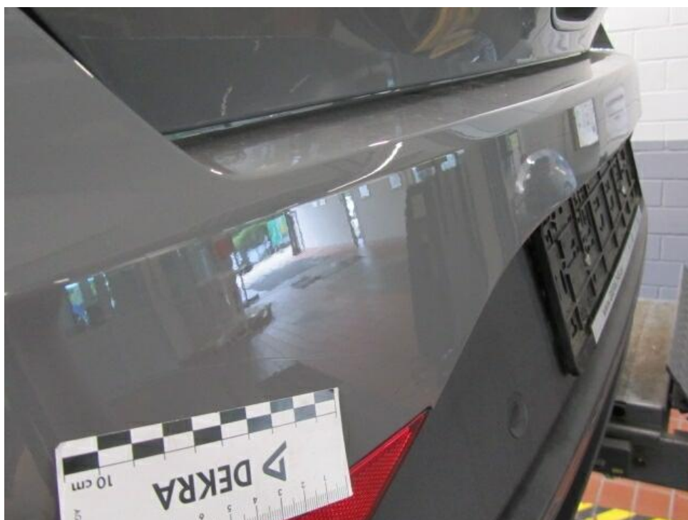
Bild 22 : Stoßfänger hinten, mehrfach eingedellt, instandsetzen und lackieren mit Lackaufbau
