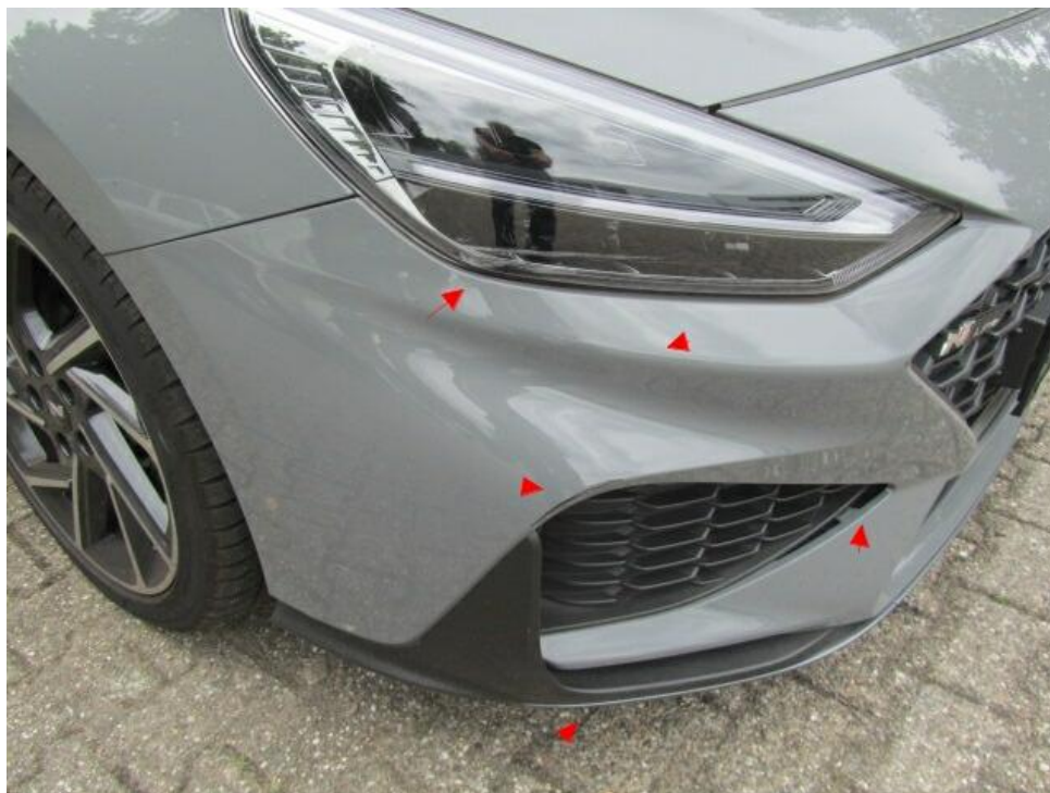
Bild 13 : Kaskoschaden vorne rechts Stossfänger verschrammt, eingekerbt, Scheinwerfer verschrammt erneuern
