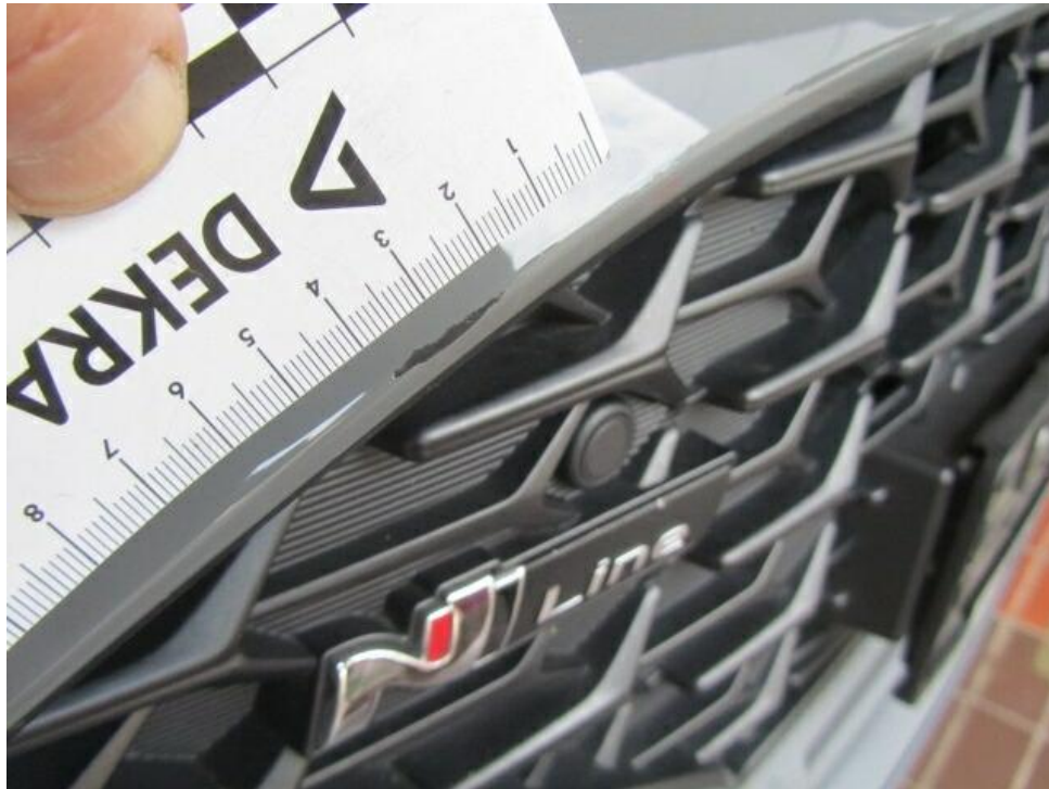
Bild 17 : Kaskoschaden vorne rechts Stossfänger verschrammt, eingekerbt,
