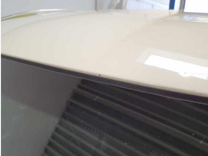
Damage 7: Roof: Roof (Anätzung-Mehrkosten möglich) - Paint defect - Conditioning
