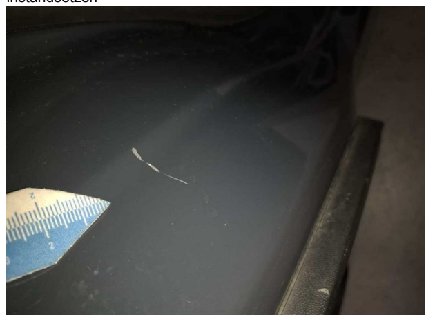
Beschädigung #3: Seitenwand rechts: Einstieg - Kratzer - Smart Repair
