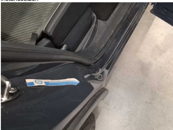
Beschädigung #3: Seitenwand rechts: Einstieg - Kratzer - Smart Repair
