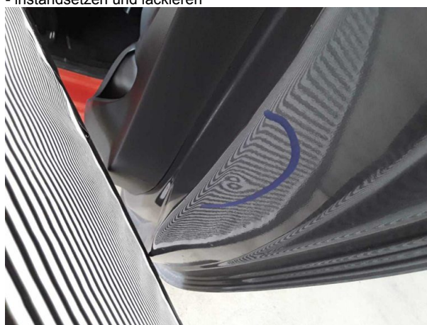
Beschädigung #9: Tür hinten rechts: Tür - Delle / Lackschad... - instandsetzen und lackieren
