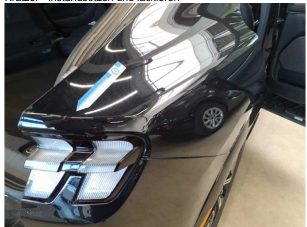
Beschädigung #5: Seitenwand rechts: Seitenwand - Kratzer - instandsetzen und lackieren
