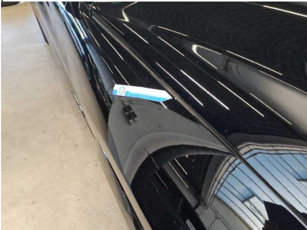
Beschädigung #2: Kotflügel rechts: Kotflügel rechts - Kratzer - auslegen / polieren
