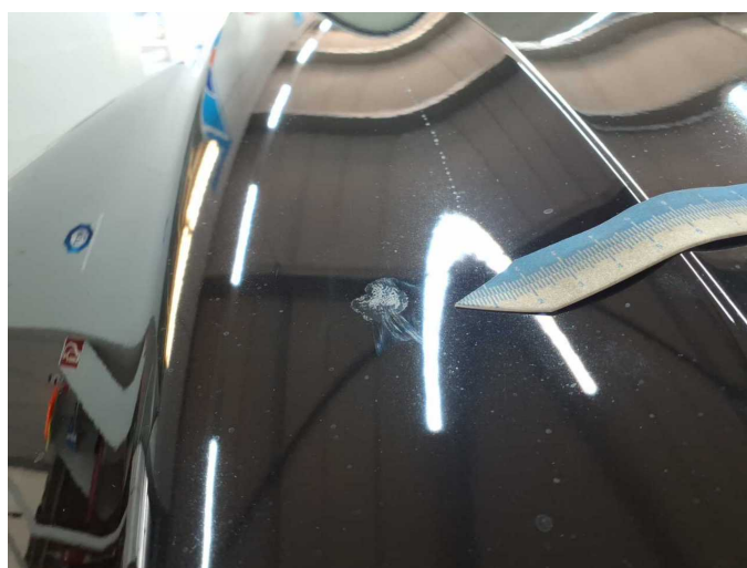
Damage 4: Bonnet: Bonnet (Verätzungen-Mehrkosten möglich) - Paint defect - Conditioning
