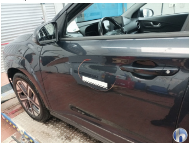
1. Tür Vorne - Links Kratzer - Lackieren
