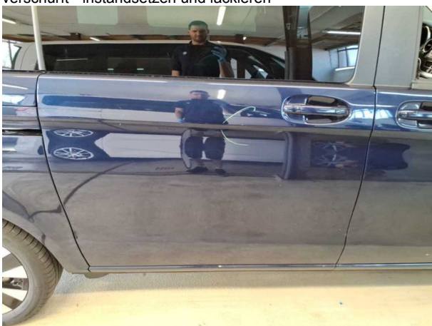
Beschädigung #8: Schiebetür rechts: Schiebetür mit Glasscheib... verkratzt / verschürft - instandsetzen und lackieren
