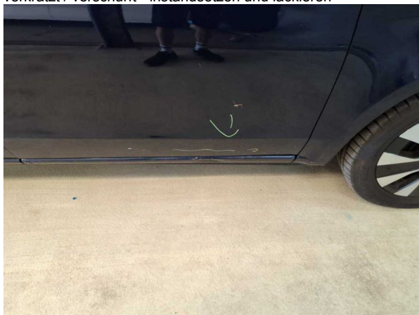
Beschädigung #5: Schweller rechts: Schweller - verkratzt / verschürft - instandsetzen und lackieren
