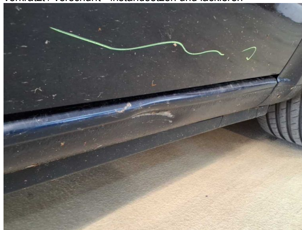
Beschädigung #5: Schweller rechts: Schweller - verkratzt / verschürft - instandsetzen und lackieren
