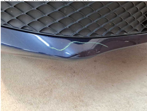
Beschädigung #7: Stossfänger vorn: Stossfänger vorn - verkratzt / verschürft - instandsetzen und lackieren
