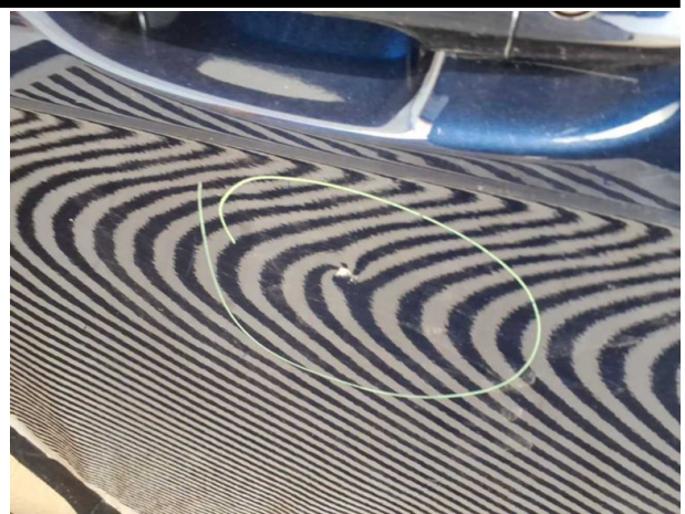
Beschädigung #9: Tür vorn links: Tür - Delle / Lackschaden - instandsetzen und lackieren
