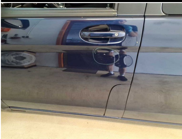
Beschädigung #9: Tür vorn links: Tür - Delle / Lackschaden - instandsetzen und lackieren
