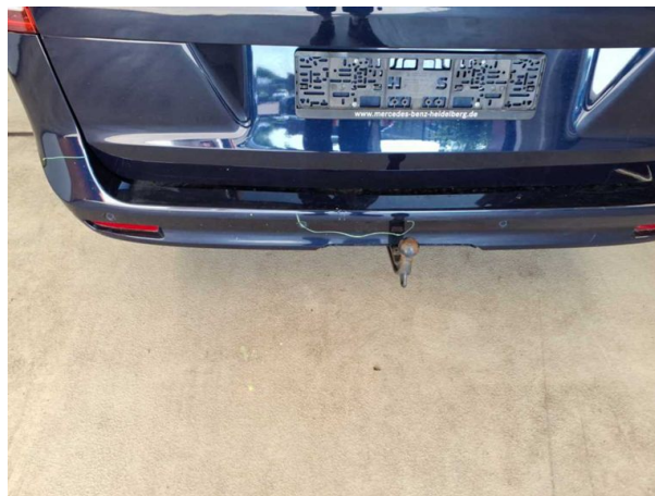
Beschädigung #4: Stoßfänger hinten: Stoßfänger hinten - verkratzt / verschürft - instandsetzen und lackieren
