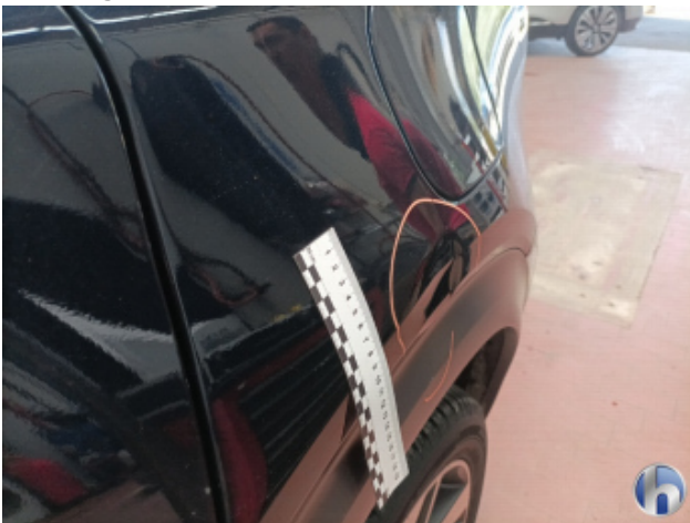
2. Seitenwand - Hinten - Links Beschädigt - Instandsetzen und Lackieren
