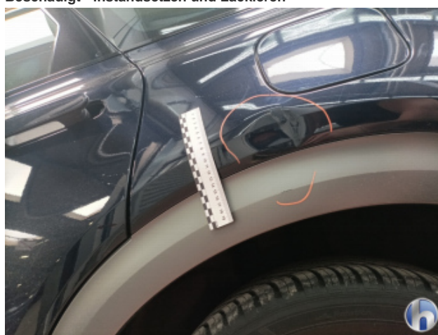
2. Seitenwand - Hinten - Links Beschädigt - Instandsetzen und Lackieren
