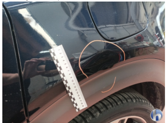
2. Seitenwand - Hinten - Links Beschädigt - Instandsetzen und Lackieren
