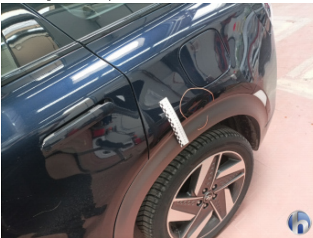
2. Seitenwand - Hinten - Links Beschädigt - Instandsetzen und Lackieren
