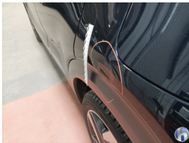
2. Seitenwand - Hinten - Links Beschädigt - Instandsetzen und Lackieren
