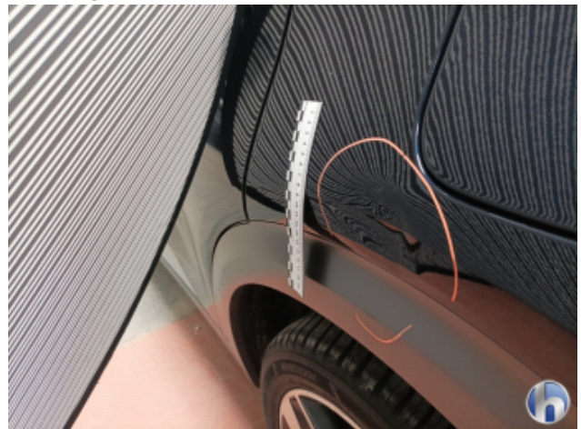
2. Seitenwand - Hinten - Links Beschädigt - Instandsetzen und Lackieren
