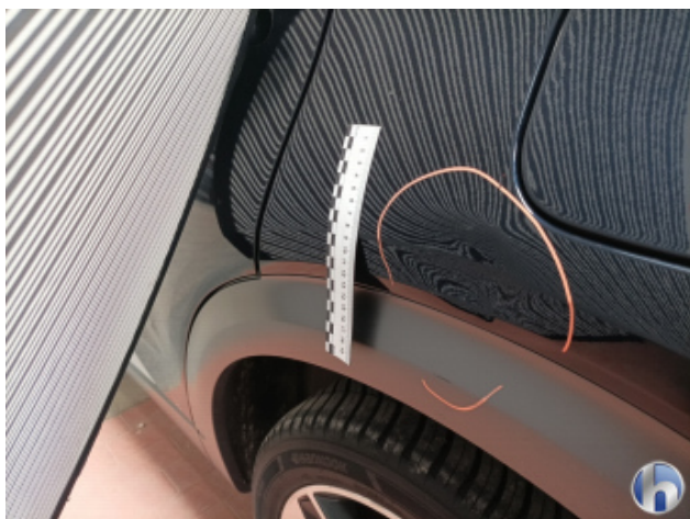
2. Seitenwand - Hinten - Links Beschädigt - Instandsetzen und Lackieren
