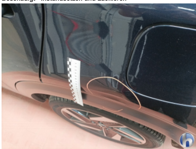
2. Seitenwand - Hinten - Links Beschädigt - Instandsetzen und Lackieren
