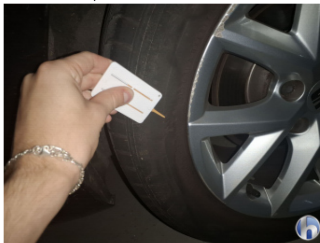
4. Reifen Hinten - Rechts Riss - Erneuern
