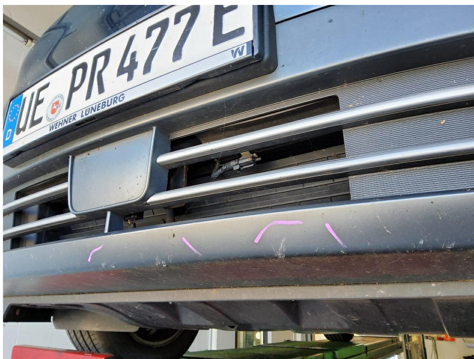
Bild 4 : Spoiler Stoßfänger vorne verschrammt
