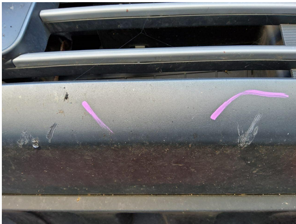
Bild 5 : Spoiler Stoßfänger vorne verschrammt
