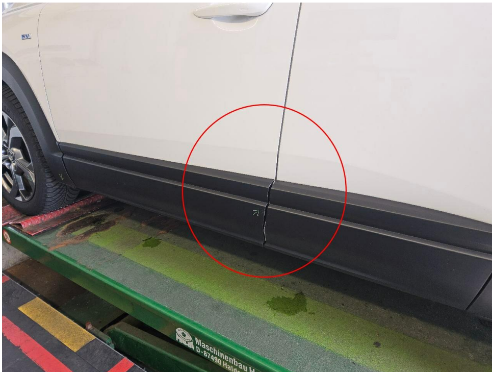
Bild 14 : Türkantenschutz vorne links, verschrammt
