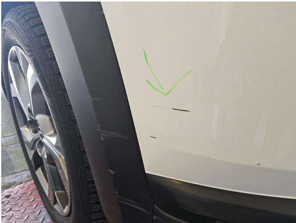
Bild 18 : Streifschaden vorne rechts (Stoßfänger,Radlaufblende)
