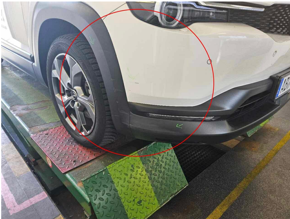
Bild 16 : Streifschaden vorne rechts (Stoßfänger,Radlaufblende)
