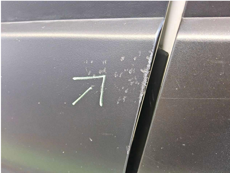
Bild 15 : Türkantenschutz vorne links, verschrammt
