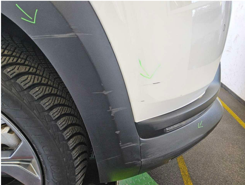
Bild 19 : Streifschaden vorne rechts (Stoßfänger,Radlaufblende)
