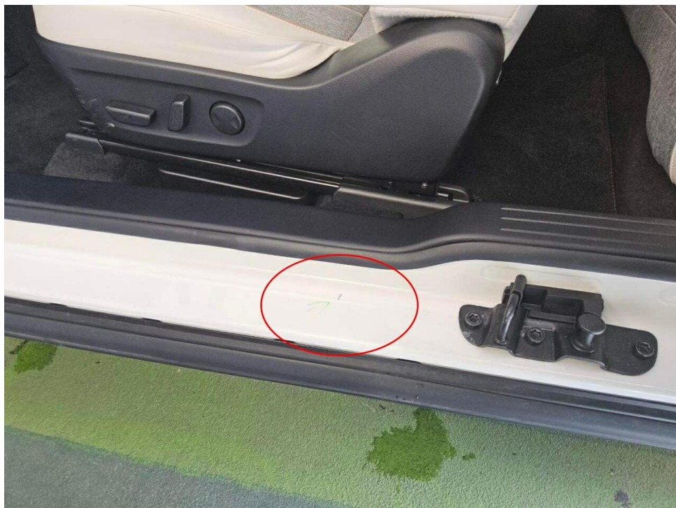
Bild 22 : Tür hinten links Einstieg Lackierung, verschrammt, smart repair
