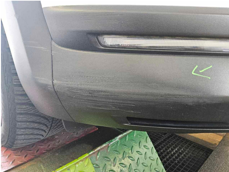
Bild 17 : Streifschaden vorne rechts (Stoßfänger,Radlaufblende)
