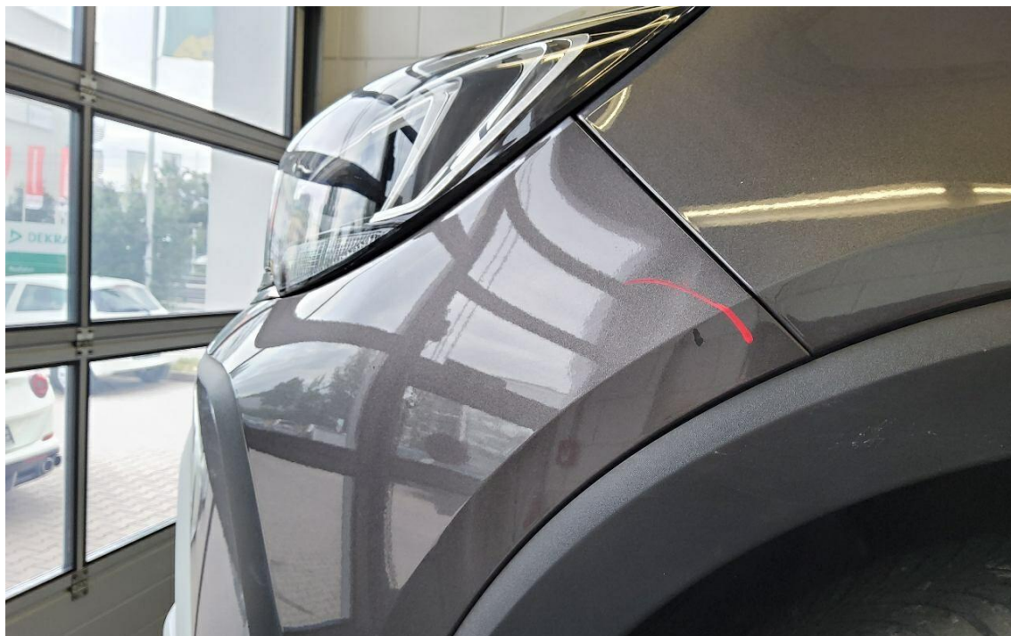
Bild 17 : Stoßfänger vorne verschrammt
