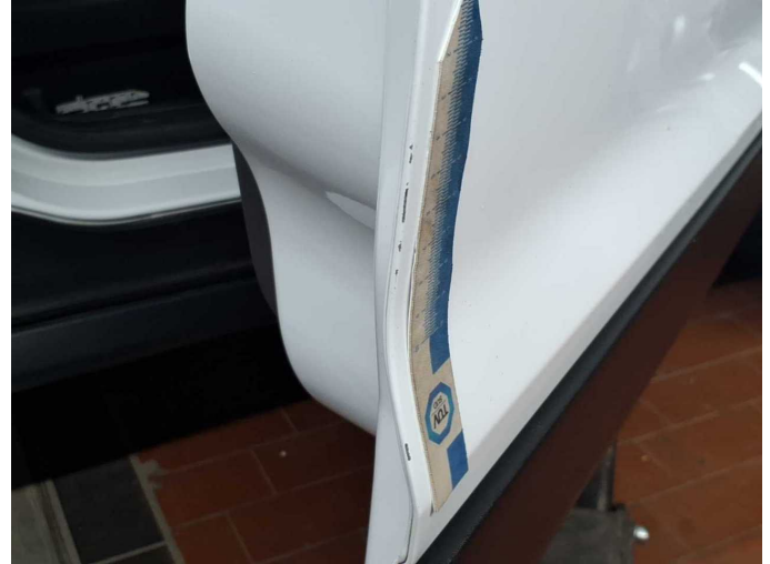
Damage 3: Door - front right side: Door edge - Scratch(es) - Smart repair
