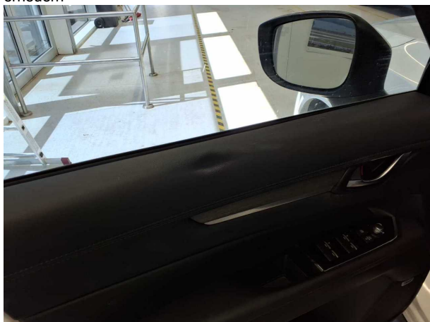
Beschädigung #12: Verkleidungen/Abdeckungen: Türverkleidung vorn links - verformt - erneuern
