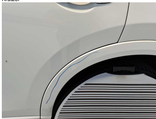
Beschädigung #3: Seitenwand links: Radlauf - Kratzer - Smart Repair
