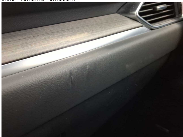
Beschädigung #13: Instrumententafel: Instrumententafel (Blende) - verformt - erneuern
