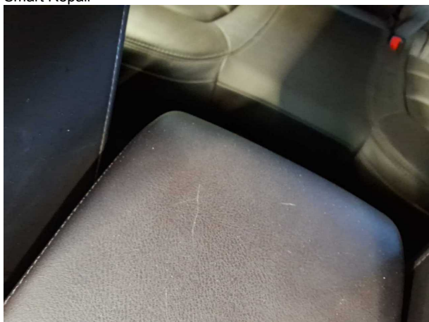
Beschädigung #6: Sitz hinten: Mittelarmlehne - verkratzt / verschürft - Smart Repair
