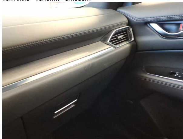
Beschädigung #13: Instrumententafel: Instrumententafel (Blende) - verformt - erneuern
