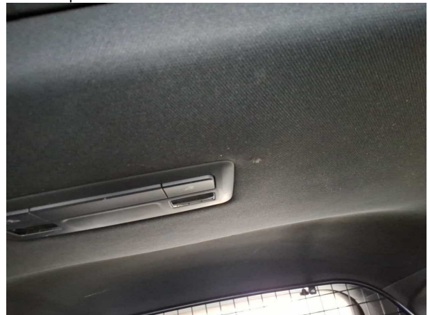
Beschädigung #8: Verkleidungen/Abdeckungen: Dachhimmel - Löcher - Smart Repair
