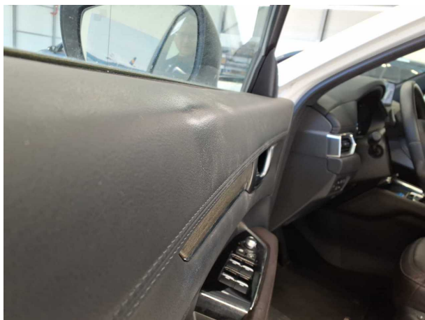
Beschädigung #12: Verkleidungen/Abdeckungen: Türverkleidung vorn links - verformt - erneuern
