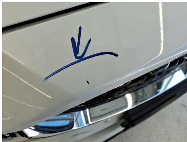
Beschädigung #10: Stossfänger vorn: Blende Stossfänger vorn - Kratzer - lackieren
