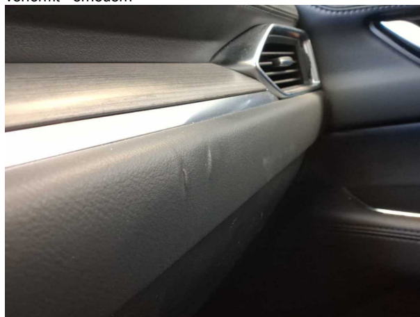
Beschädigung #13: Instrumententafel: Instrumententafel (Blende) - verformt - erneuern
