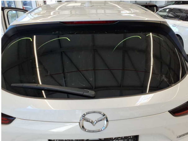
Beschädigung #9: Verglasung: Heckscheibe - Kratzer - Wertminderung
