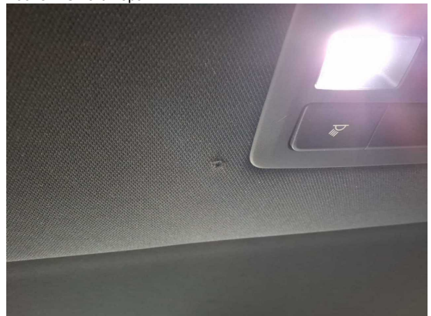
Beschädigung #8: Verkleidungen/Abdeckungen: Dachhimmel - Löcher - Smart Repair
