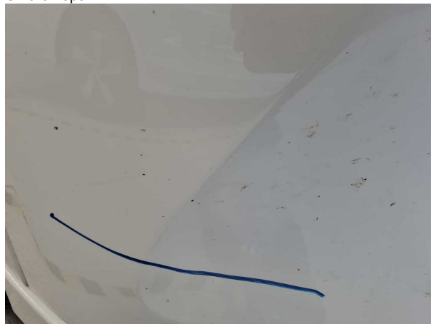
Beschädigung #7: Stossfänger vorn: Stossfänger vorn - Kratzer - Smart Repair
