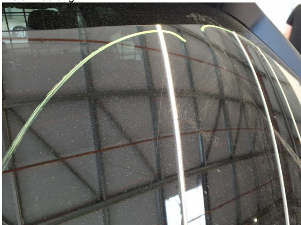
Beschädigung #9: Verglasung: Heckscheibe - Kratzer - Wertminderung
