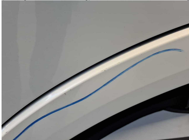
Beschädigung #3: Seitenwand links: Radlauf - Kratzer - Smart Repair
