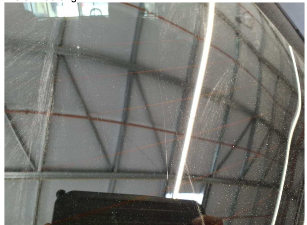
Beschädigung #9: Verglasung: Heckscheibe - Kratzer - Wertminderung
