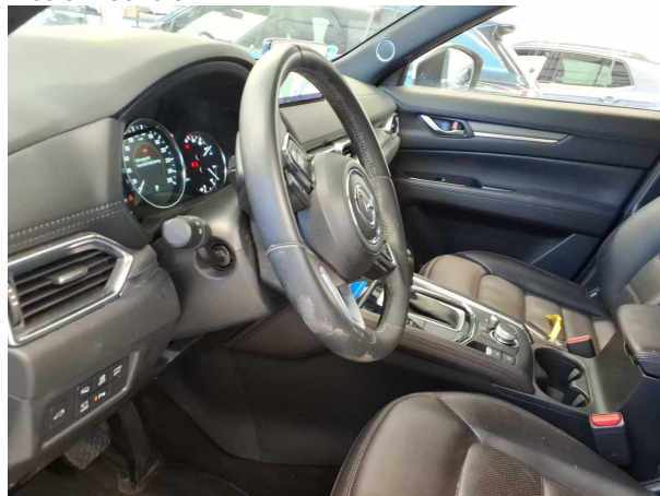
Beschädigung #11: Lenkanlage: Lenkrad - verkratzt / verschürft - erneuern
