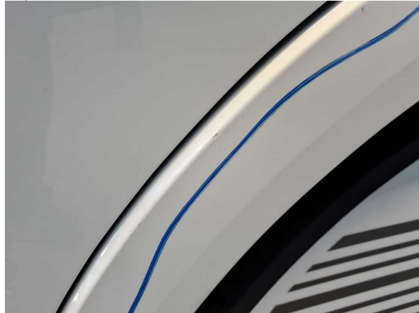
Beschädigung #3: Seitenwand links: Radlauf - Kratzer - Smart Repair
