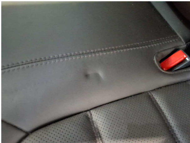
Beschädigung #4: Sitz hinten: Sitzbezug - verformt - Wertminderung
