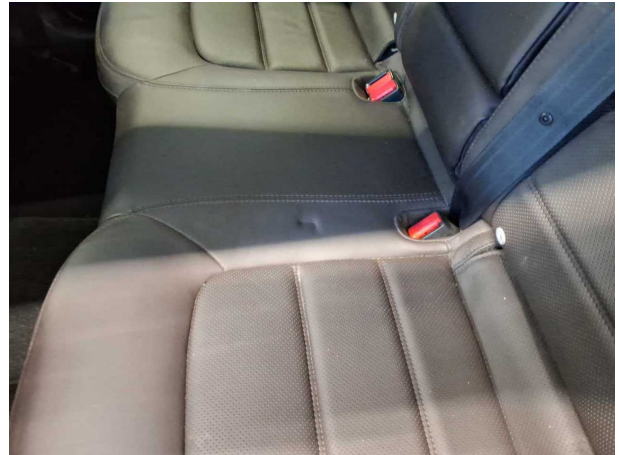
Beschädigung #4: Sitz hinten: Sitzbezug - verformt - Wertminderung
