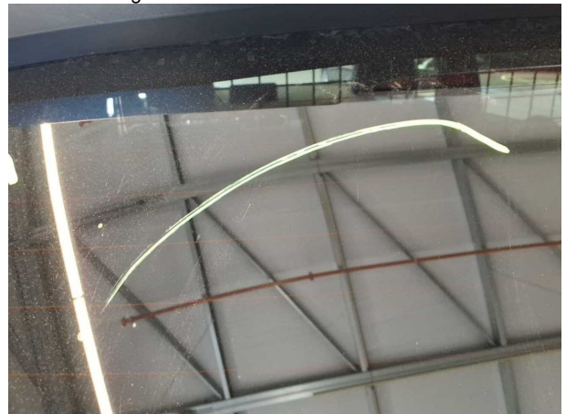
Beschädigung #9: Verglasung: Heckscheibe - Kratzer - Wertminderung
