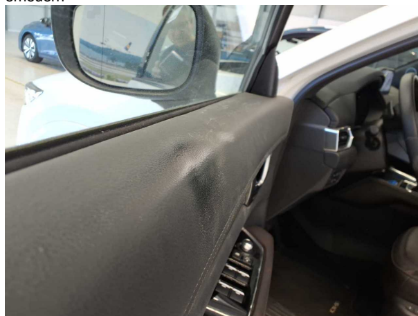
Beschädigung #12: Verkleidungen/Abdeckungen: Türverkleidung vorn links - verformt - erneuern
