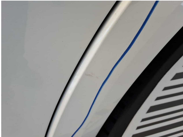
Beschädigung #3: Seitenwand links: Radlauf - Kratzer - Smart Repair
