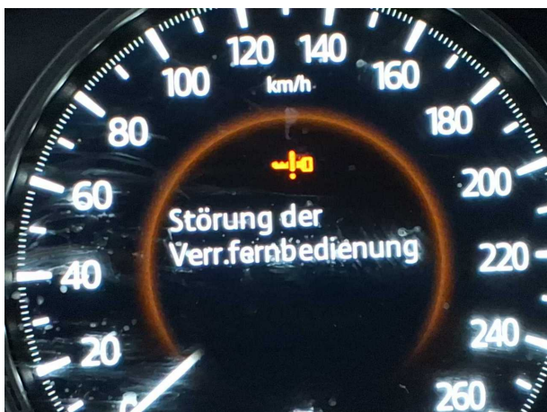
Beschädigung #2: elektronische Systeme: elektronische Systeme (Störung der Fernbedienung) - elektrischer Fehler - befunden ggf.
