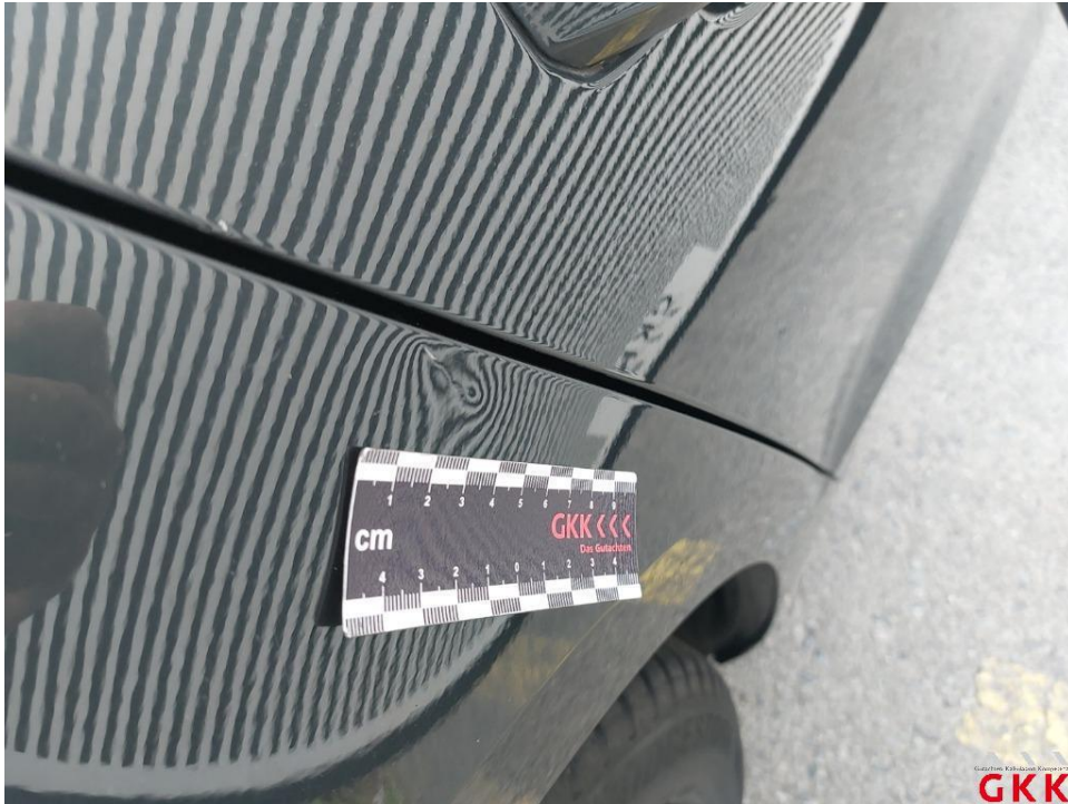
Bild 17. Seitenwand rechts, beschädigt, instand setzen - lackieren
