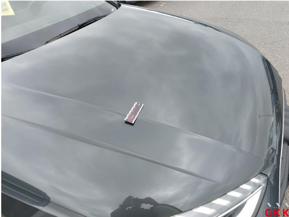
Bild 23. Motorhaube, bis 3 Dellen / Bauteil, kalt drücken
