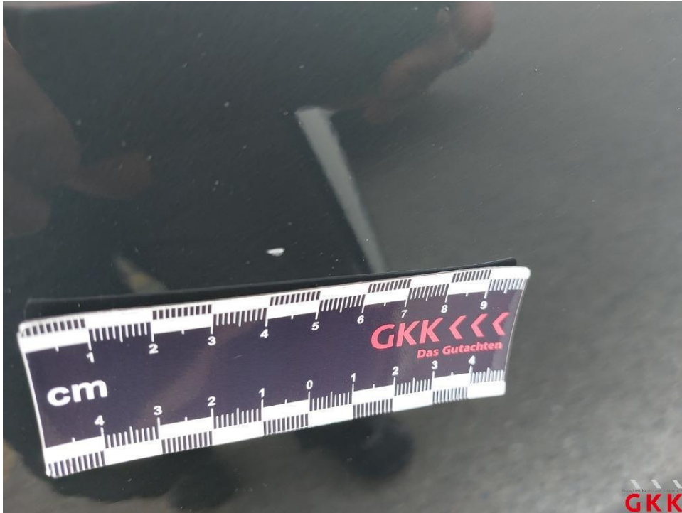
Bild 15. Tür vorne rechts, beschädigt, auslegen, schleifen, polieren
