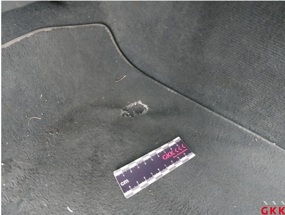
Bild 13. Fußmatte(n), vorne links, beschädigt, ersetzen
