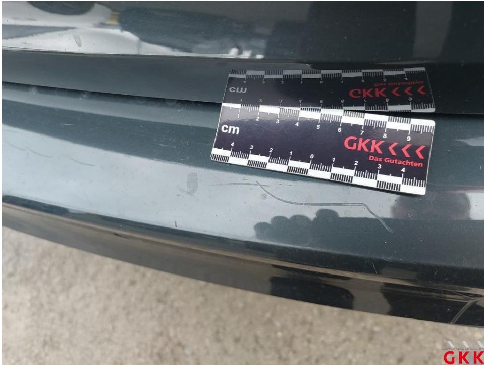
Bild 19. Stoßfänger hinten, Verkleidung -lackiert-, verkratzt, lackieren
