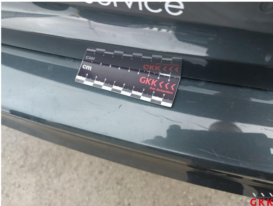
Bild 20. Stoßfänger hinten, Verkleidung -lackiert-, verkratzt, lackieren
