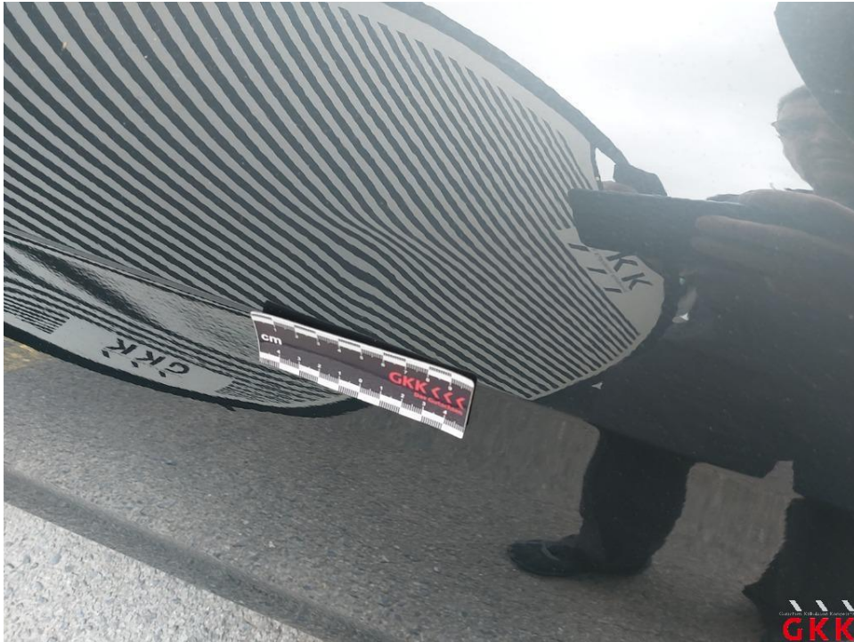
Bild 29. Tür vorne rechts, bis 3 Dellen / Bauteil, kalt drücken
