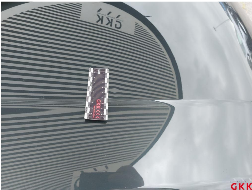
Bild 24. Motorhaube, bis 3 Dellen / Bauteil, kalt drücken
