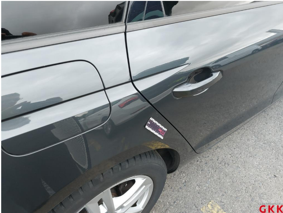
Bild 16. Seitenwand rechts, beschädigt, instand setzen - lackieren
