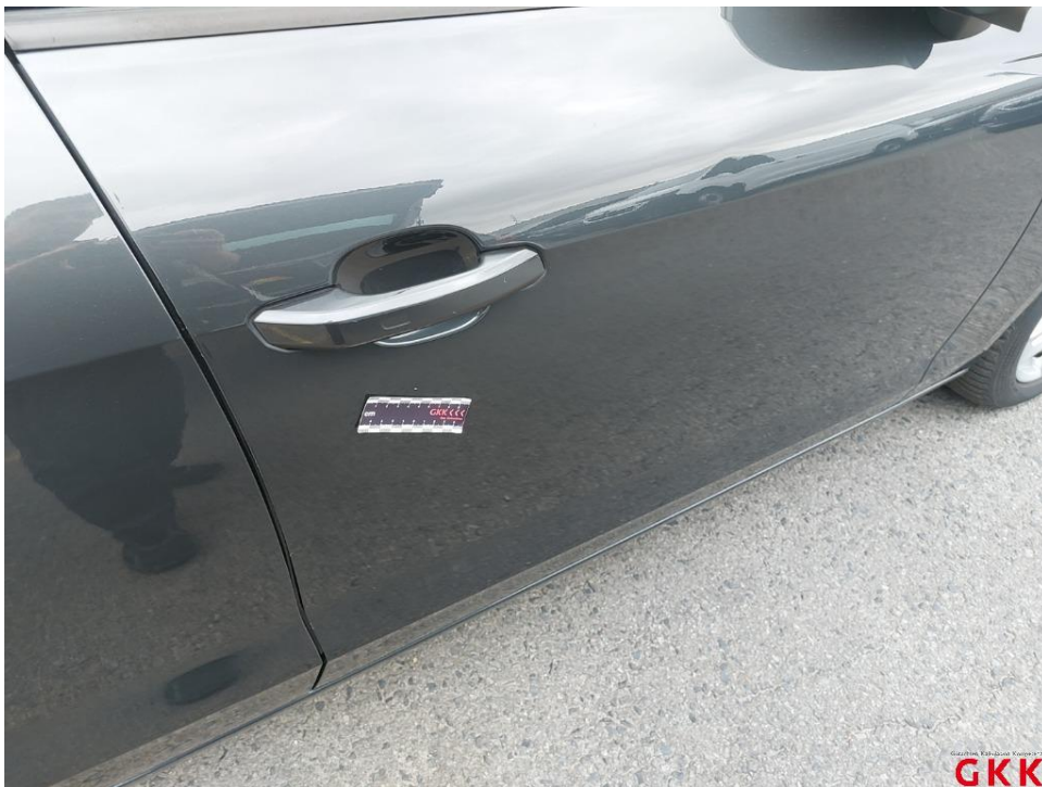
Bild 14. Tür vorne rechts, beschädigt, auslegen, schleifen, polieren
