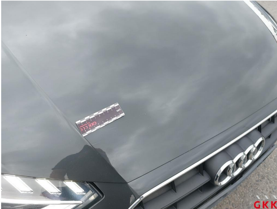
Bild 25. Motorhaube, verkratzt, lackieren
