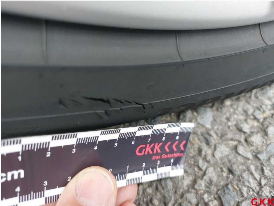
Bild 31. Reifen, vorne rechts, beschädigt, ersetzen
