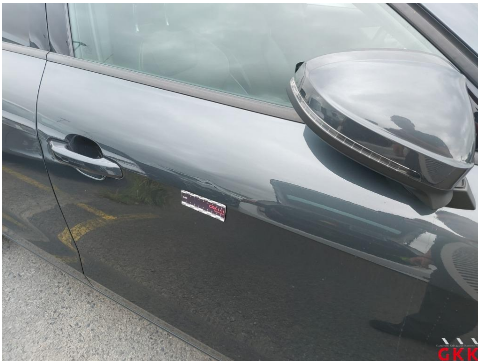
Bild 28. Tür vorne rechts, bis 3 Dellen / Bauteil, kalt drücken
