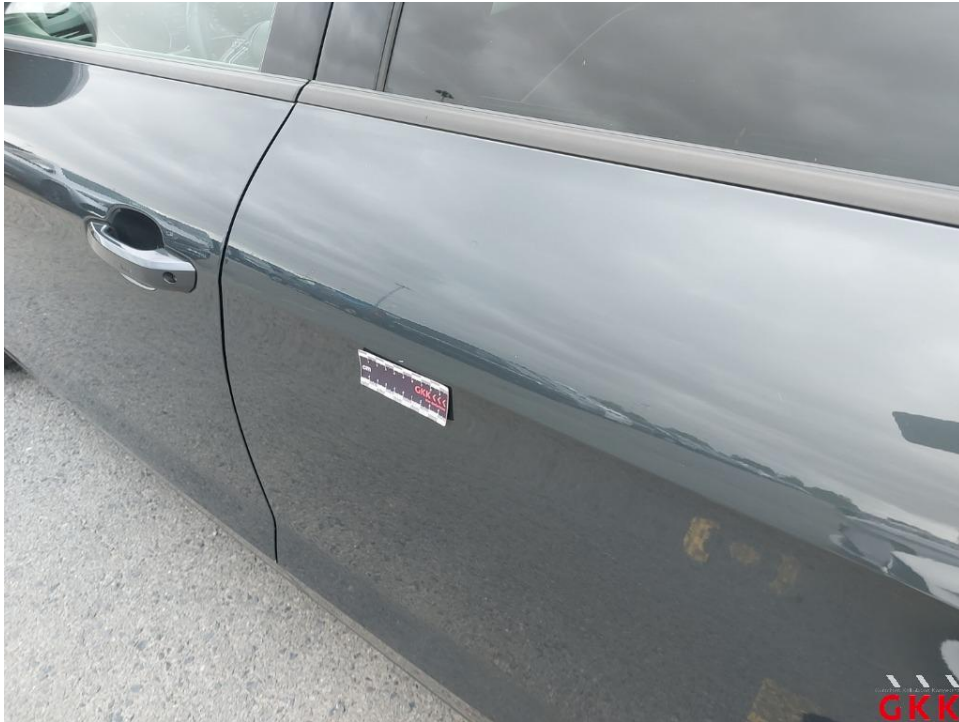
Bild 21. Tür hinten links, verkratzt, auslegen, schleifen, polieren
