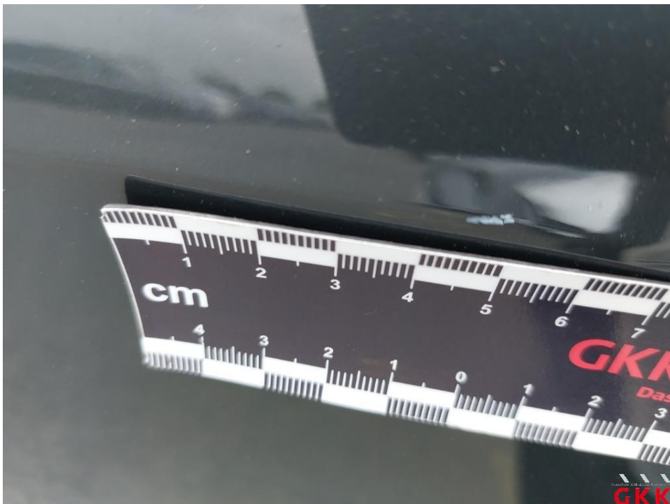
Bild 22. Tür hinten links, verkratzt, auslegen, schleifen, polieren
