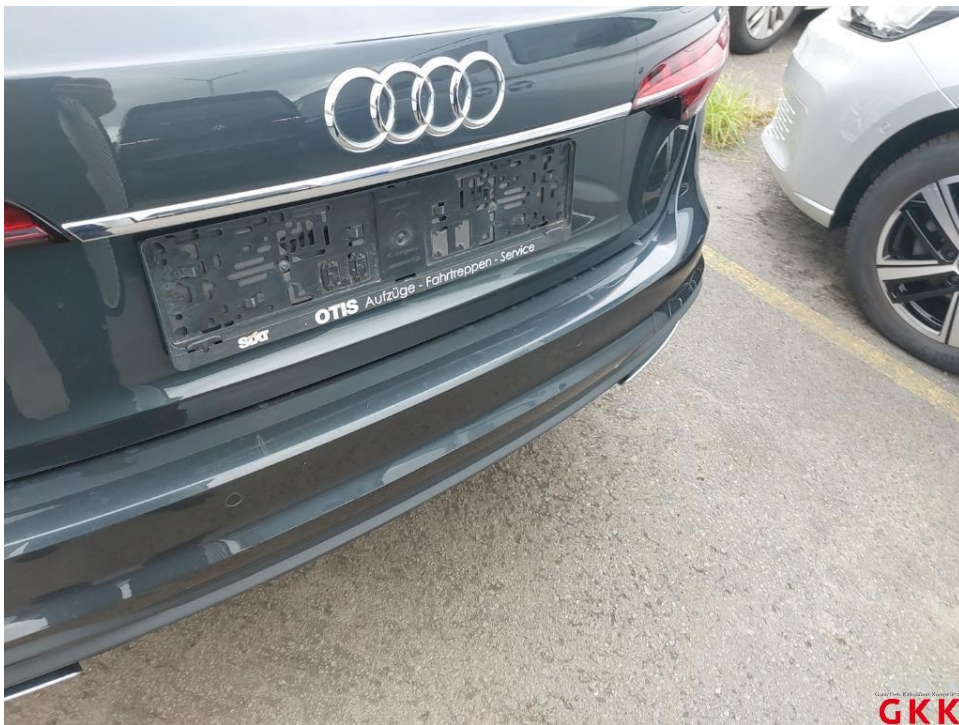
Bild 18. Stoßfänger hinten, Verkleidung -lackiert-, verkratzt, lackieren
