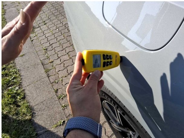
Nachlackierung 1: Seitenwand rechts
