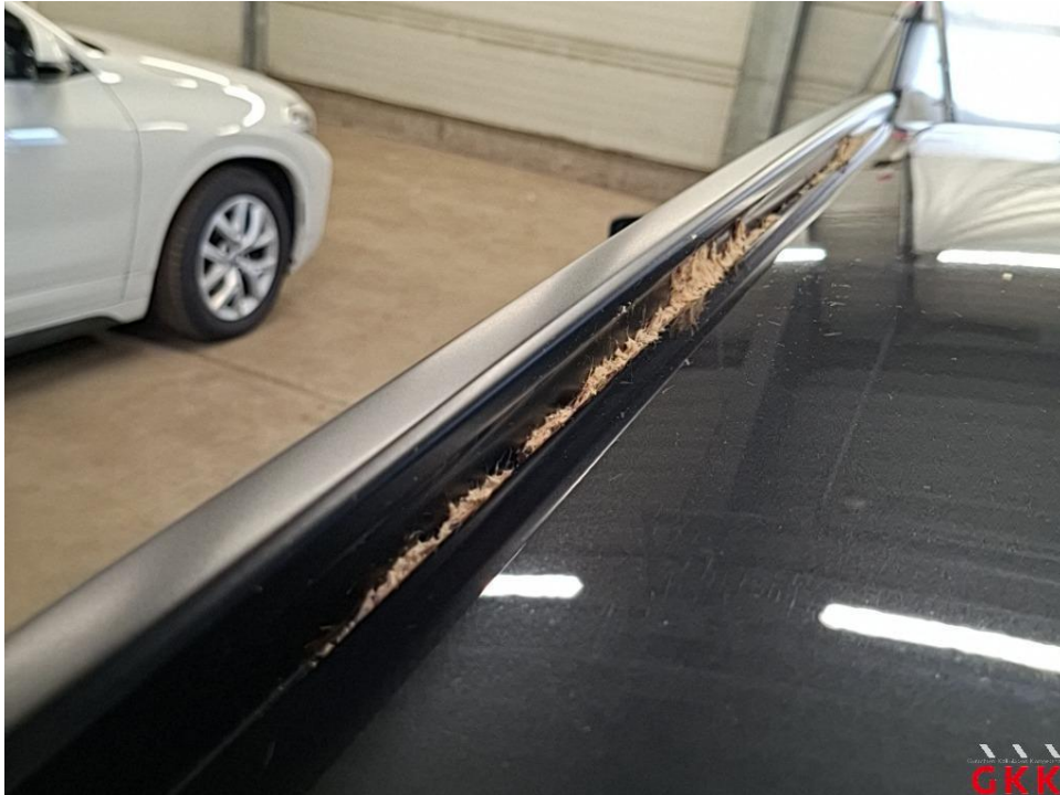
Bild 23 Fahrzeug, außen, Anhaftungsspuren, aufbereiten
