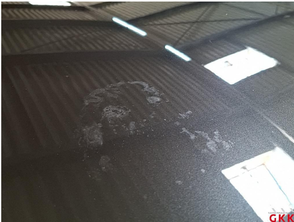
Bild 22 Fahrzeug, außen, Anhaftungsspuren, aufbereiten
