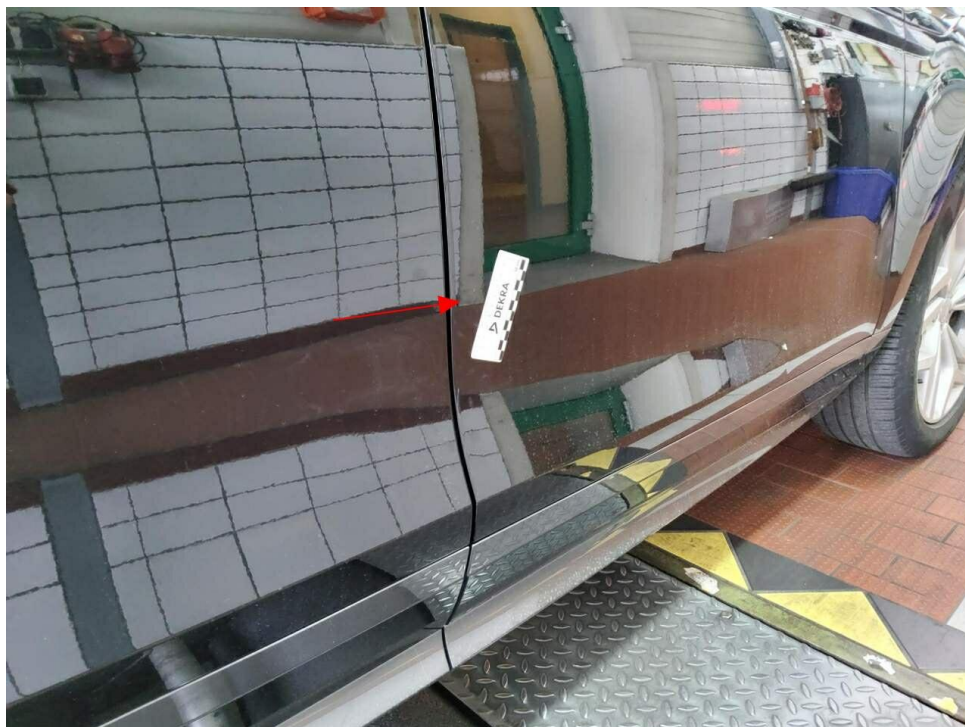
Bild 16 : Tür vorne rechts, eingedellt, instandsetzen und lackieren mit Lackaufbau
