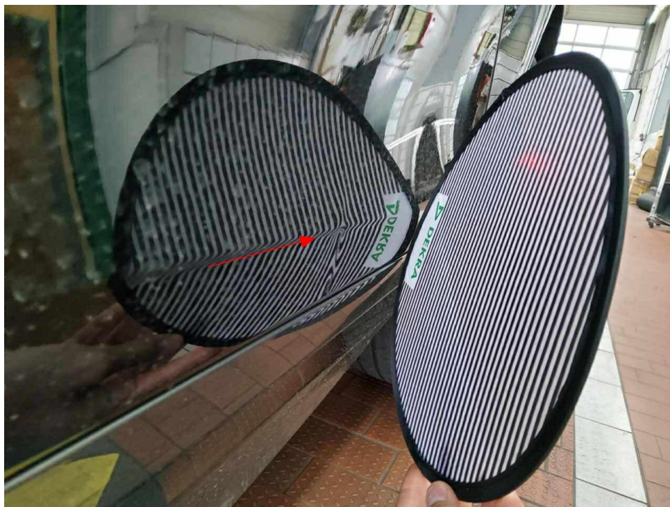
Bild 14 : Tür vorne rechts, eingedellt, instandsetzen und lackieren mit Lackaufbau
