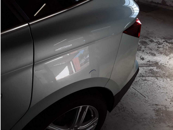
Beschädigung #2: Seitenwand links: Seitenwand - Delle(n) - sanft instandsetzen
