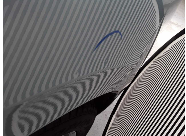
Beschädigung #2: Seitenwand links: Seitenwand - Delle(n) - sanft instandsetzen
