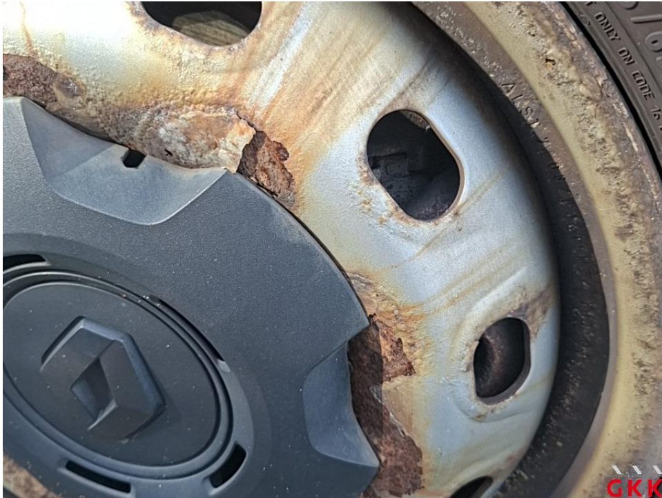
Bild 19. Stahlrad, vorne rechts, korrodiert, ersetzen
