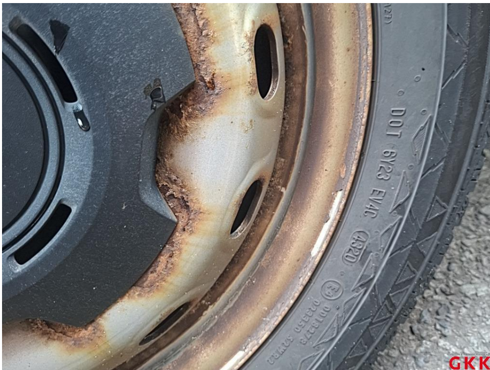
Bild 22. Stahlrad, hinten rechts, korrodiert, ersetzen
