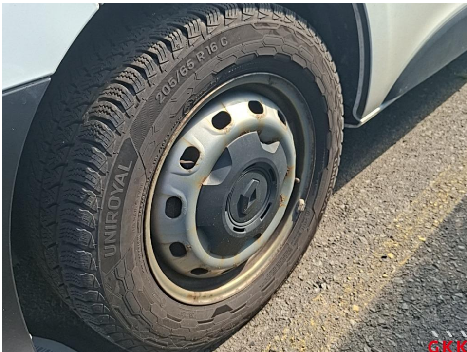
Bild 32. Stahlrad, vorne links, korrodiert, ersetzen
