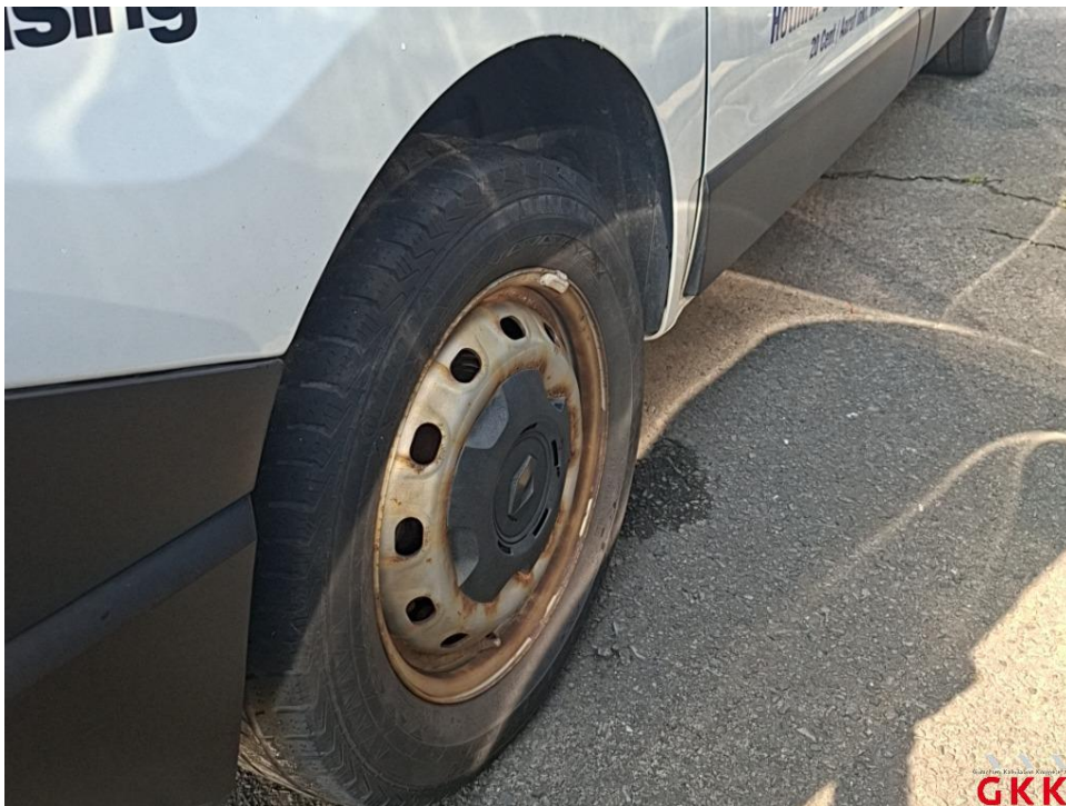
Bild 20. Stahlrad, hinten rechts, korrodiert, ersetzen
