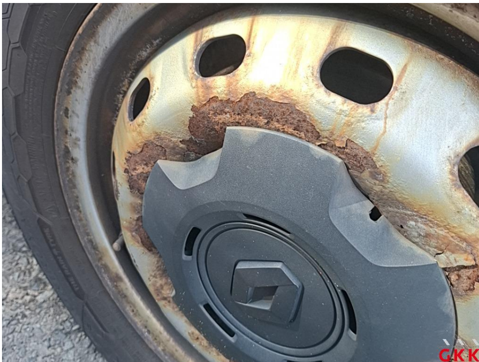
Bild 18. Stahlrad, vorne rechts, korrodiert, ersetzen
