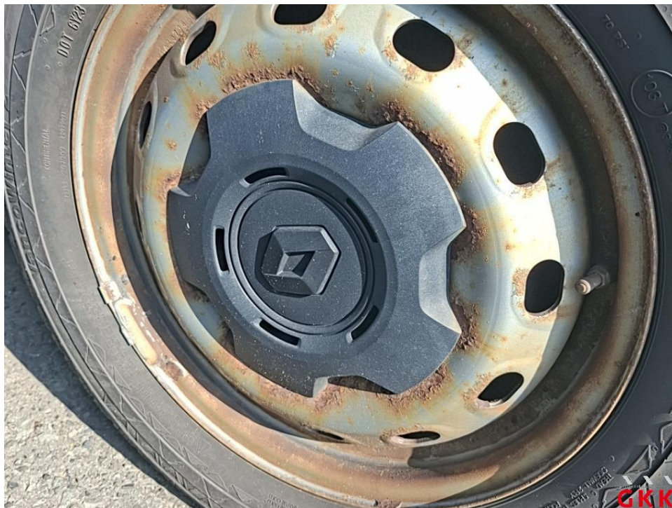
Bild 30. Stahlrad, hinten links, korrodiert, ersetzen
