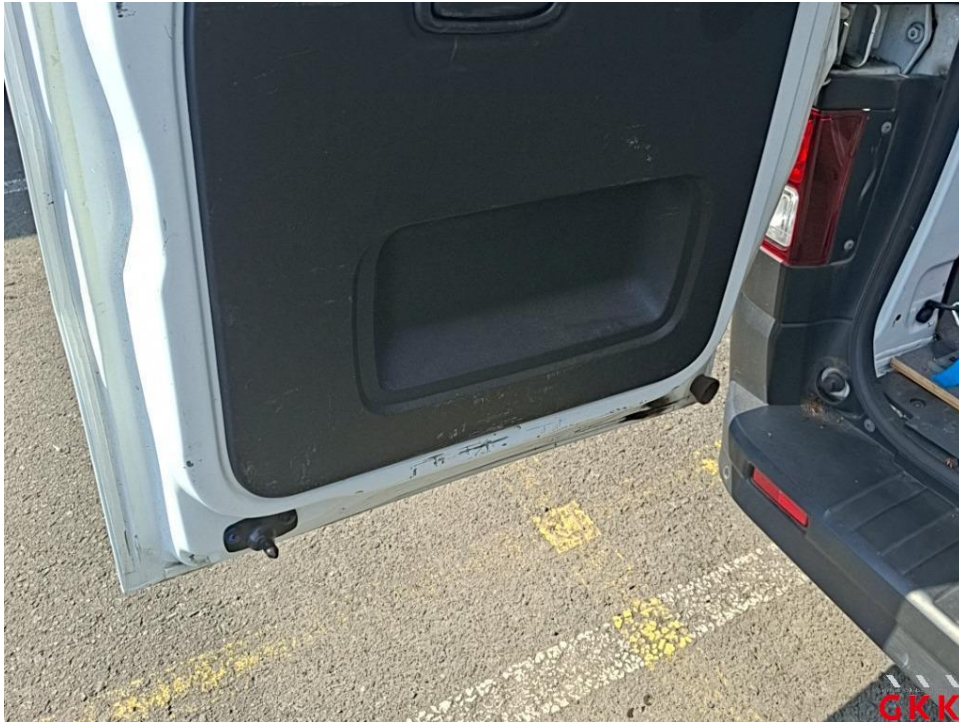
Bild 27. Hecktür links, innen, beschädigt, instand setzen - lackieren
