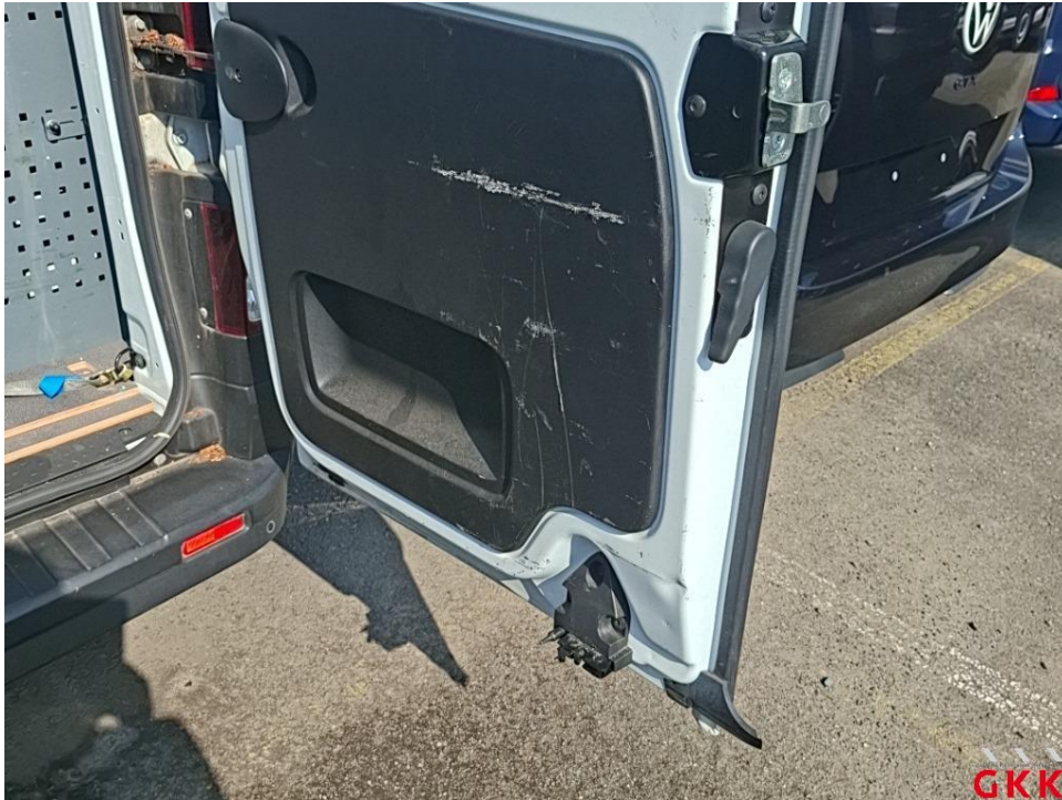
Bild 23. Hecktür rechts, Innenverkleidung, verkratzt, ersetzen
