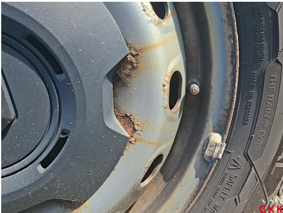
Bild 34. Stahlrad, vorne links, korrodiert, ersetzen
