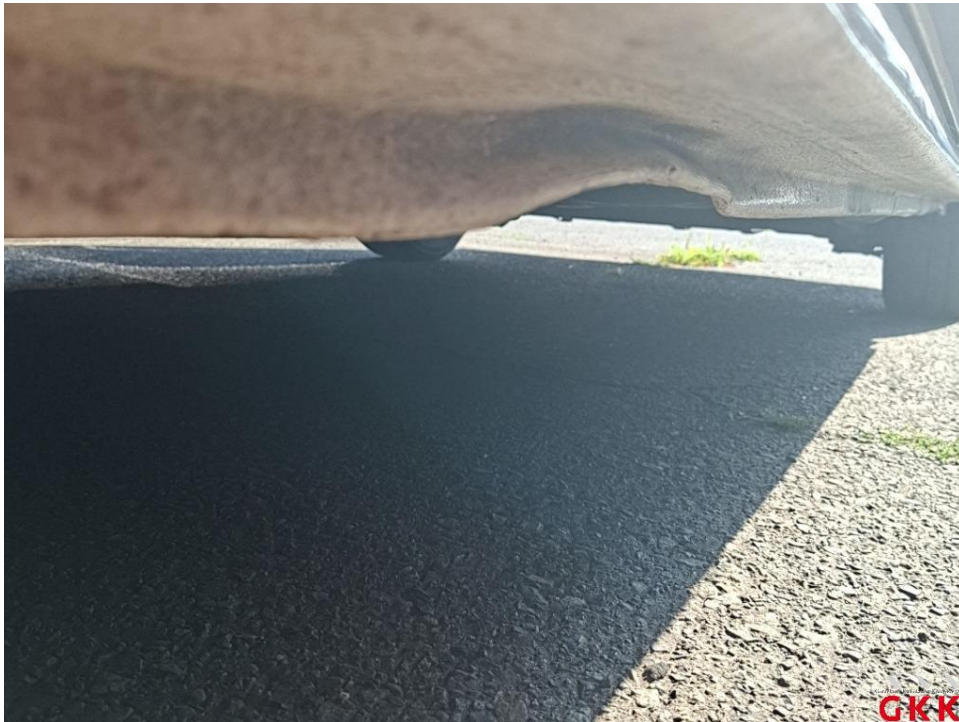
Bild 16. Schweller links, vorne, beschädigt, instand setzen - lackieren
