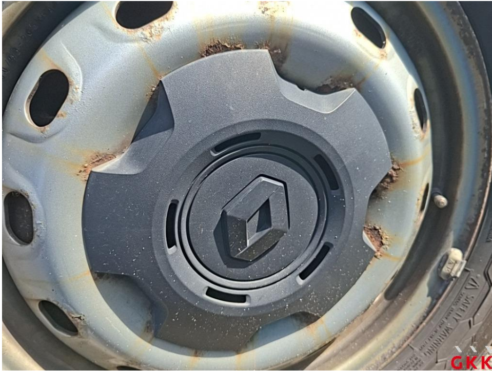
Bild 33. Stahlrad, vorne links, korrodiert, ersetzen
