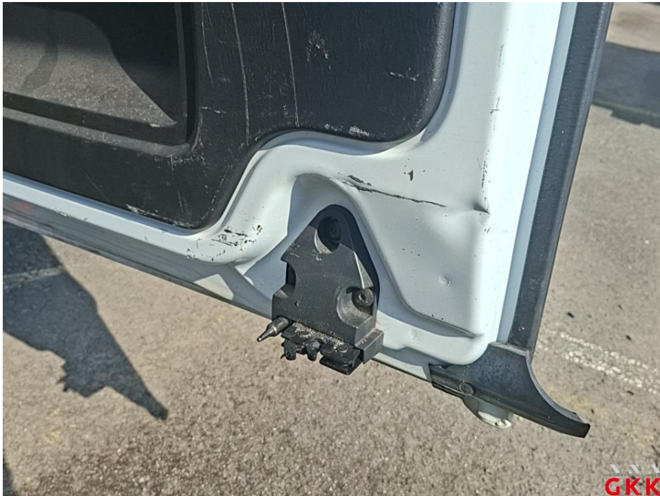
Bild 26. Hecktür rechts, innen, beschädigt, instand setzen - lackieren
