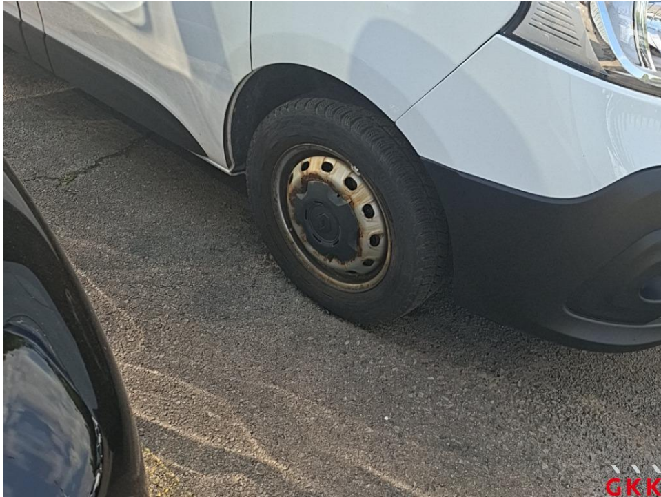
Bild 17. Stahlrad, vorne rechts, korrodiert, ersetzen
