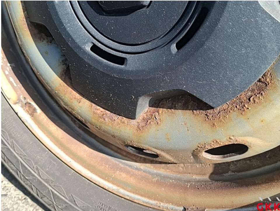
Bild 31. Stahlrad, hinten links, korrodiert, ersetzen
