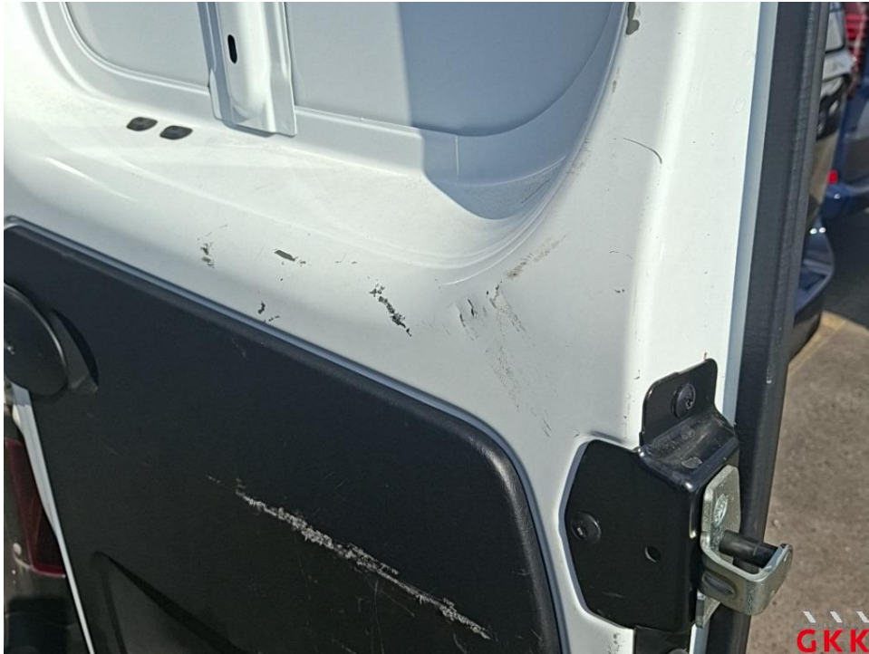
Bild 25. Hecktür rechts, innen, beschädigt, instand setzen - lackieren
