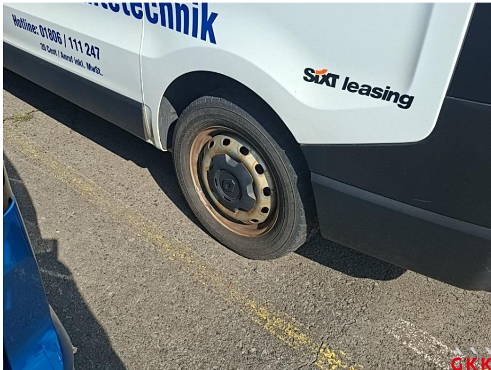
Bild 29. Stahlrad, hinten links, korrodiert, ersetzen
