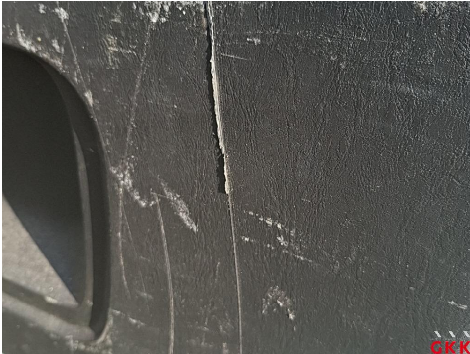
Bild 24. Hecktür rechts, Innenverkleidung, verkratzt, ersetzen
