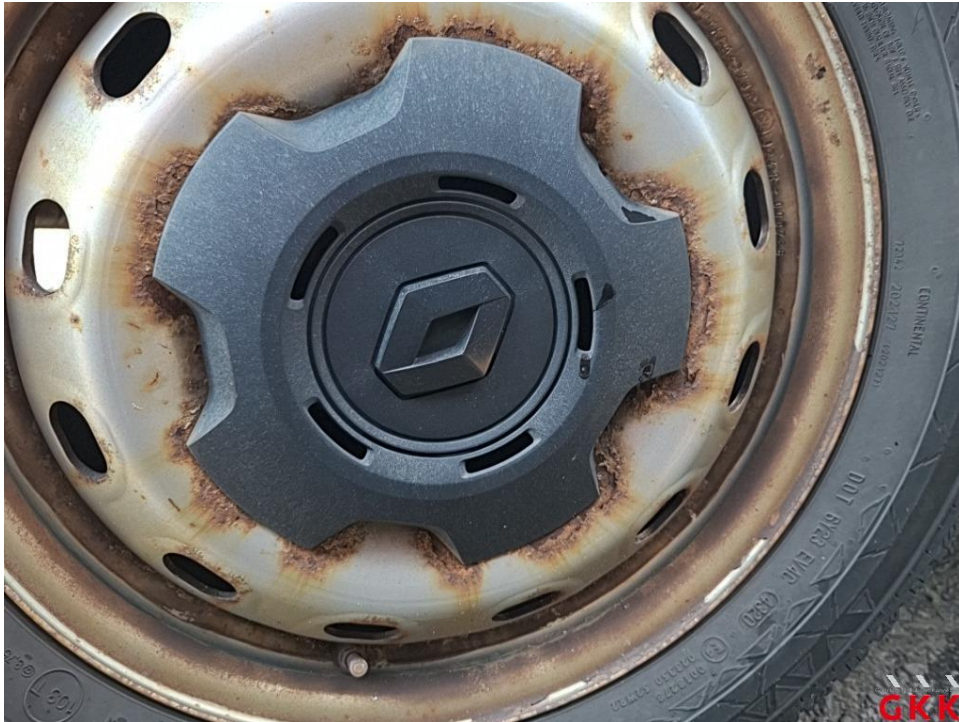
Bild 21. Stahlrad, hinten rechts, korrodiert, ersetzen
