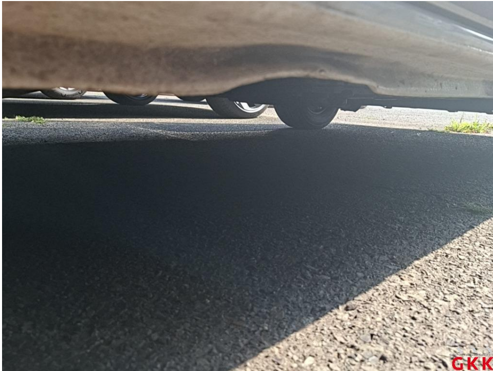
Bild 15. Schweller links, vorne, beschädigt, instand setzen - lackieren
