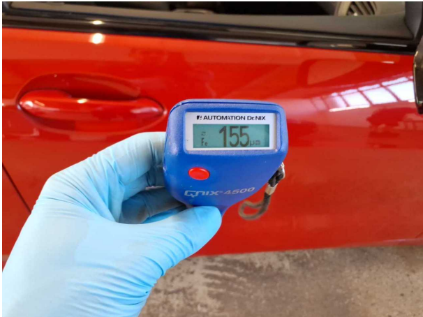
Nachlackierung 1: Seitenwand rechts, Tür vorne rechts
