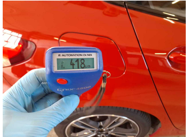
Nachlackierung 1: Seitenwand rechts, Tür vorne rechts
