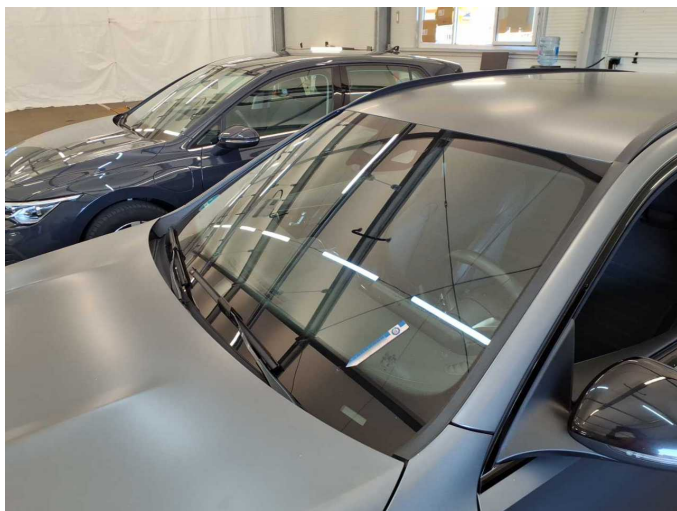
Damage 4: Vehicle glazing: Windscreen (Im Randbereich mit Rissbildung) - Stone chips - Replace
