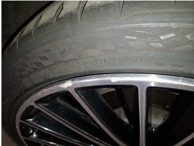
Damage 2: Wheel / tyres: Alloy rim - rear right side (Mit Materialabtrag) - Scratched - Replace
