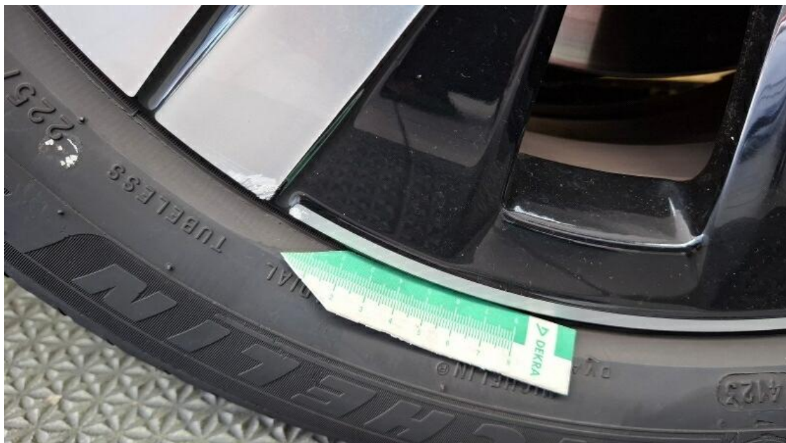
Bild 17 : Alufelge, Sommer, vorne rechts, glanzgedreht, verschrammt mit Materialabtrag
