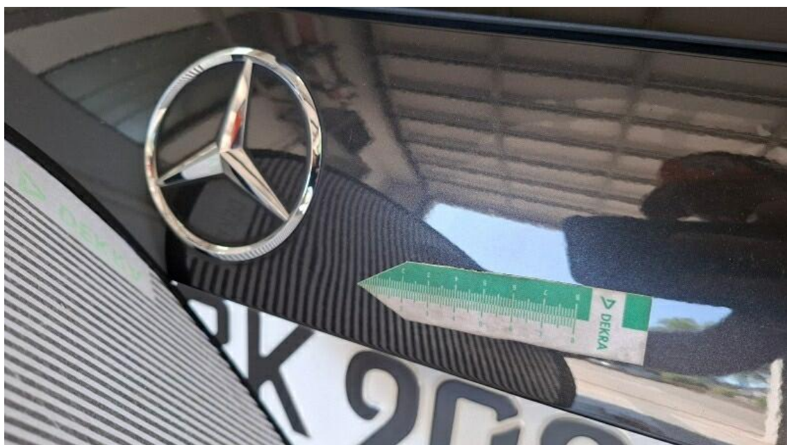
Bild 18 : Heckklappe, eingedellt, drücken
