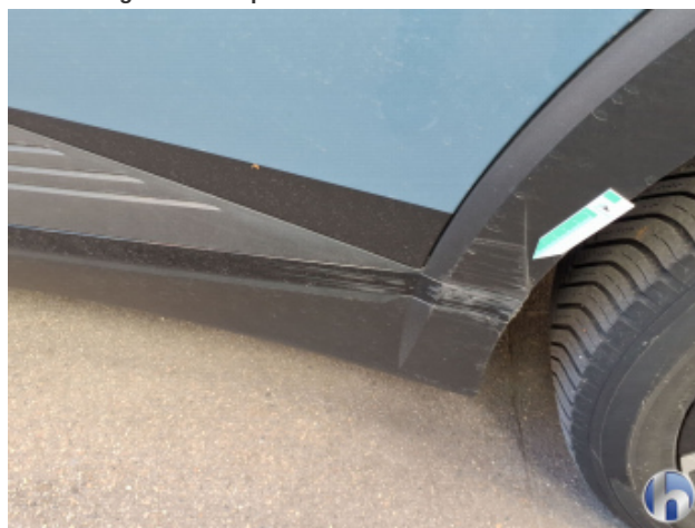
5. Türschutzleiste li.hi. Beschädigt - Erneuern
