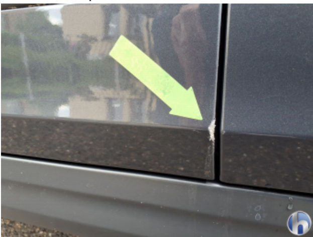
6. Tür Vorne - Links Kratzer - Instandsetzen und Lackieren
