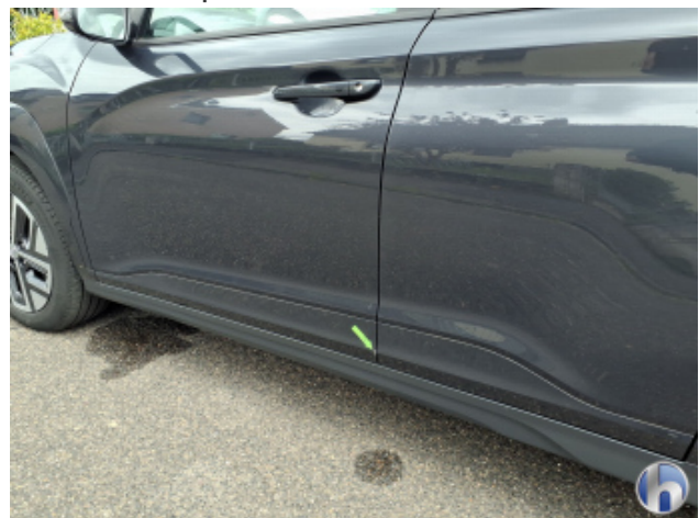
6. Tür Vorne - Links Kratzer - Instandsetzen und Lackieren
