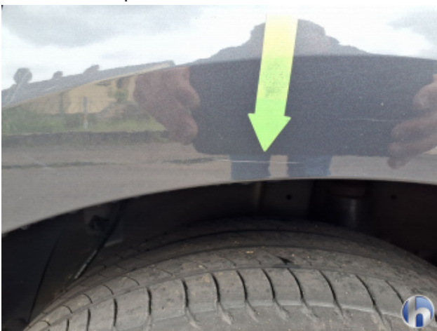
9. Seitenwand - Hinten - Links Kratzer - Smart Repair
