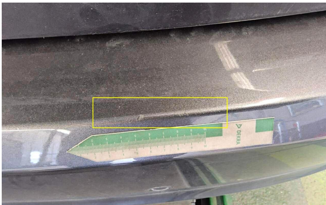
Bild 23 : Stoßfänger hinten Lackierung, verschrammt, smart repair
