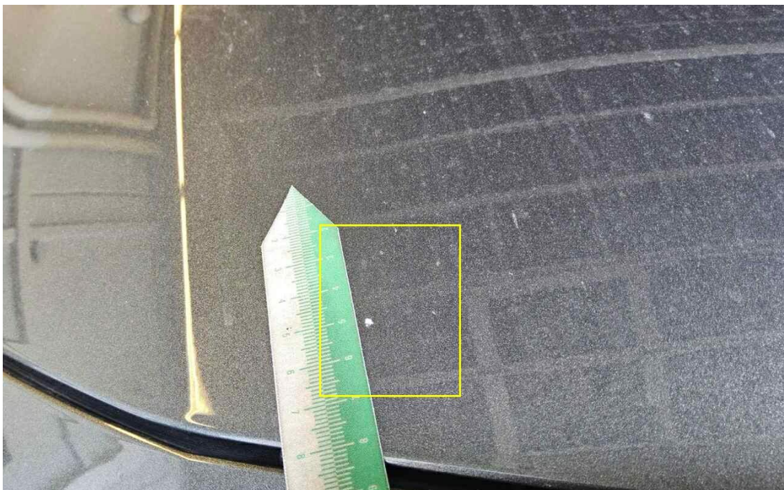
Bild 31 : Motorhaube Lackierung, Steinschlag, Gebrauchsspur
