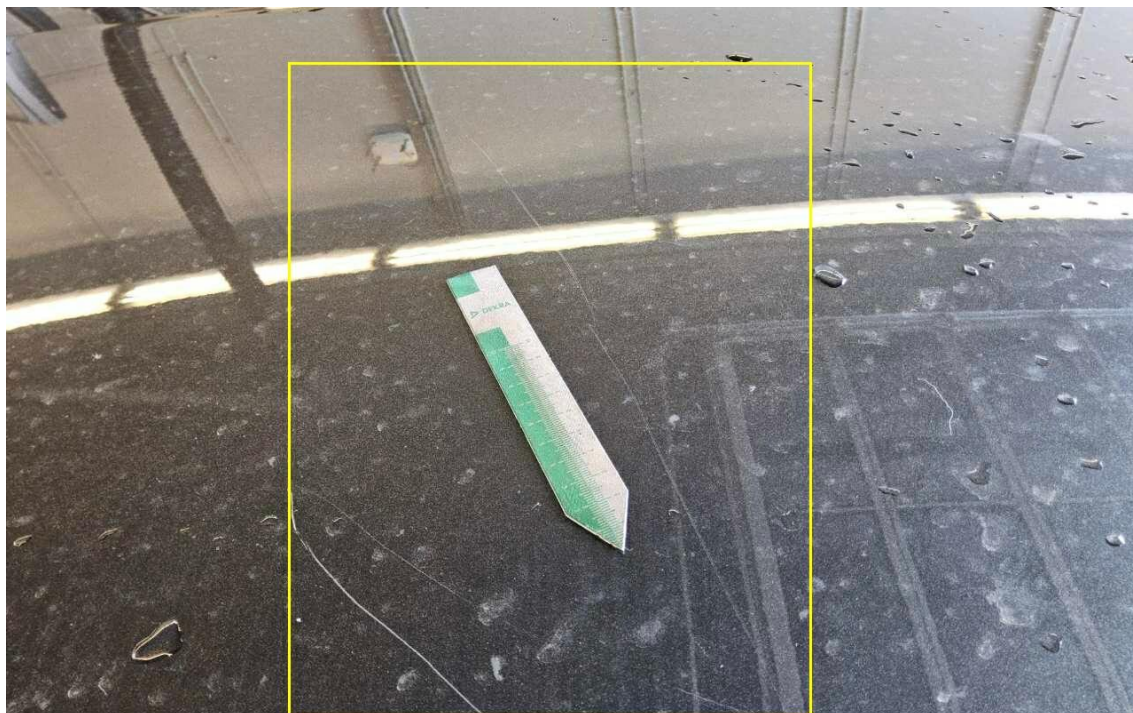
Bild 20 : Dach Lackierung, zerkratzt, lackieren mit Lackaufbau
