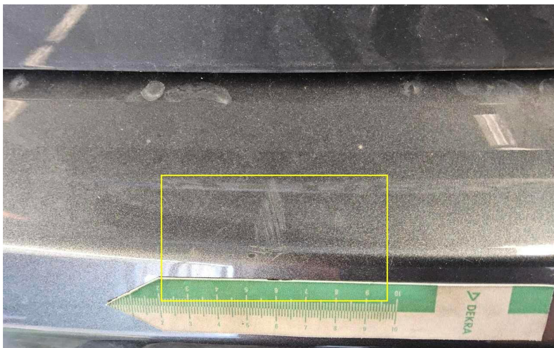
Bild 25 : Stoßfänger hinten Lackierung, verschrammt, smart repair
