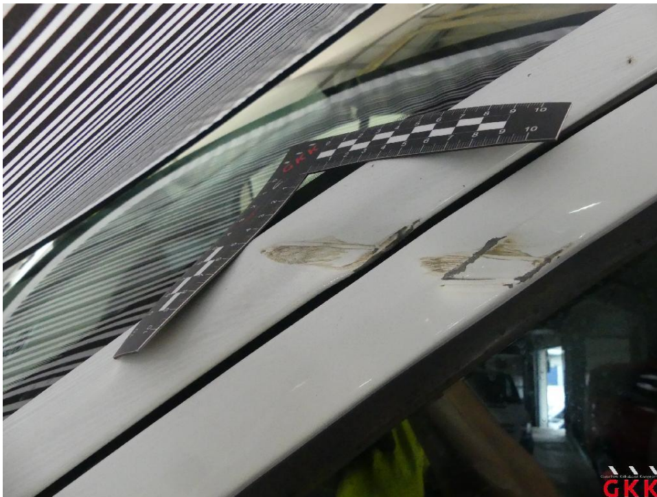
Bild 20 Tür vorne links, beschädigt, ersetzen
