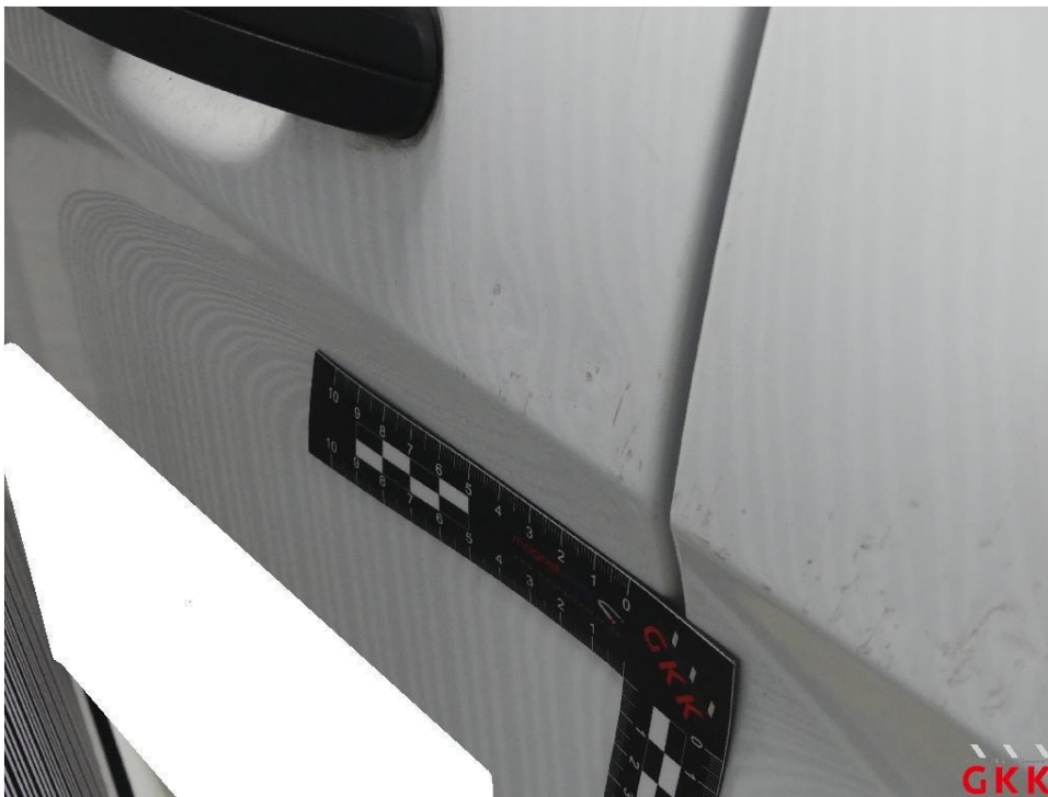
Bild 26 Schiebetür rechts, beschädigt, instand setzen - lackieren
