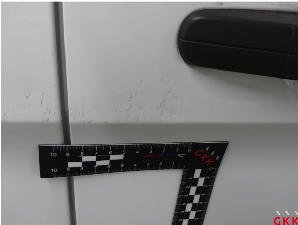
Bild 22 Tür vorne rechts, beschädigt, instand setzen - lackieren
