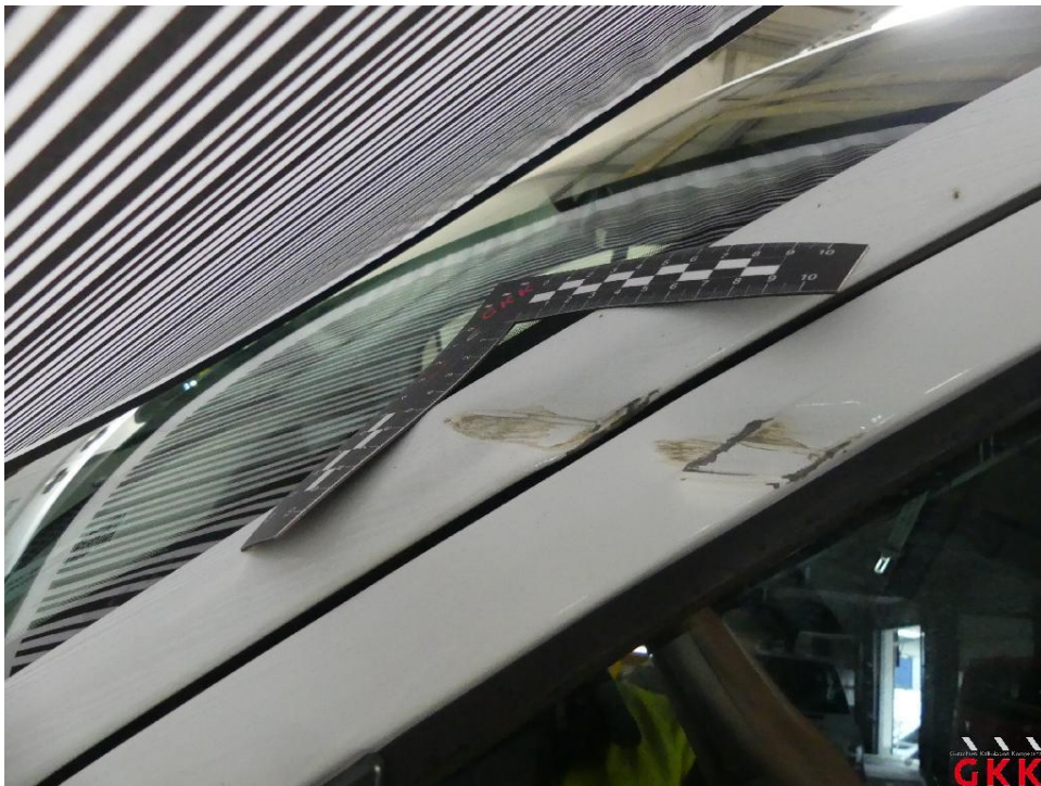
Bild 16 A- Säule links, beschädigt, instand setzen - lackieren
