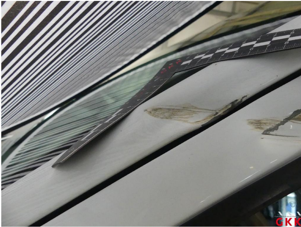
Bild 17 A- Säule links, beschädigt, instand setzen - lackieren
