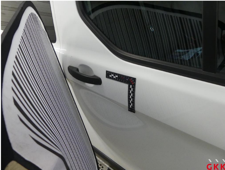
Bild 21 Tür vorne rechts, beschädigt, instand setzen - lackieren
