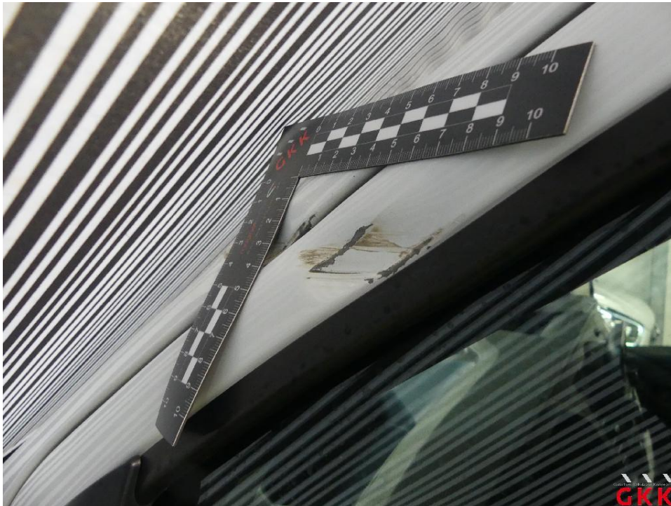
Bild 19 Tür vorne links, beschädigt, ersetzen
