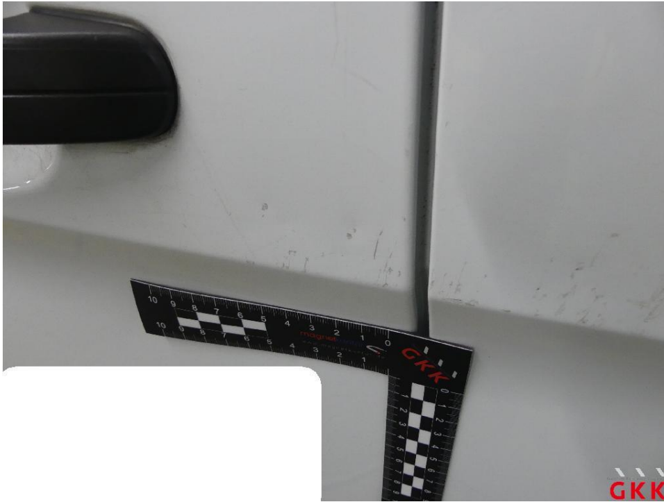
Bild 25 Schiebetür rechts, beschädigt, instand setzen - lackieren
