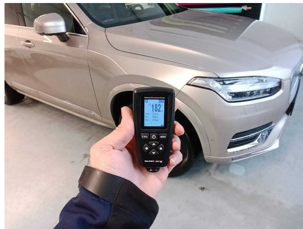
Nachlackierung 1: Kotflügel rechts, Motorhaube
