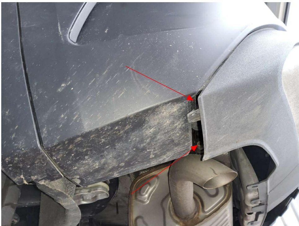
Bild 19 : Unfallschaden: Stoßfängerverkleidung/Spoiler hinten links und mittig verlagert
