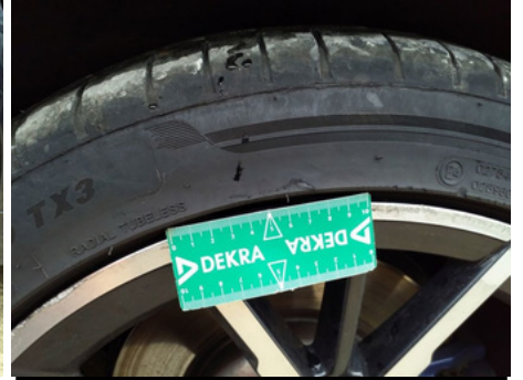
Pneu / Arrière Droit / Déchiré
