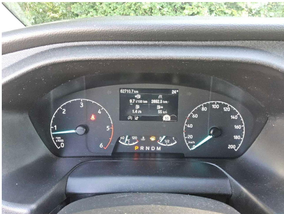
Bild 6 : Kombiinstrument (betriebsbereit) mit Km-Stand
