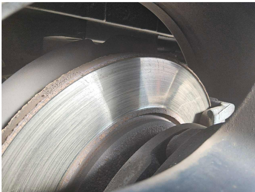
Bild 20 : Bremsscheiben hinten nah an Verschleißgrenze, Mindestmaß nach Hersteller kontrollieren
