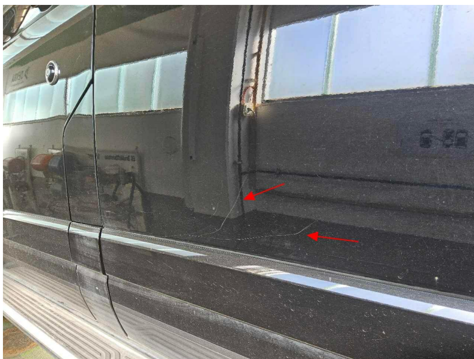
Bild 22 : Schiebetür links oberflächlich verschrammt, polierbar
