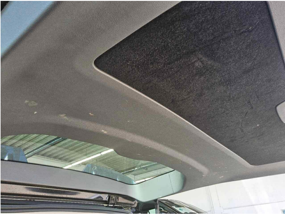
Bild 12 : Verkleidung Heckklappe verschrammt
