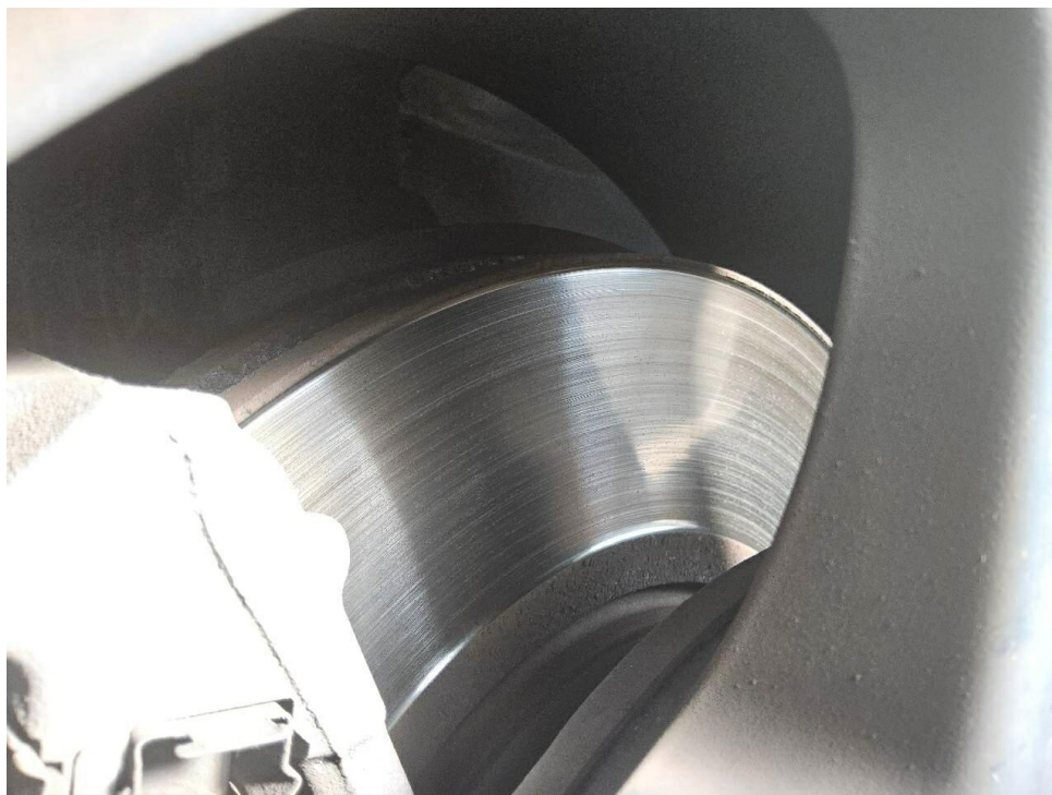
Bild 19 : Bremsscheiben vorne nah an Verschleißgrenze, Mindestmaß nach Hersteller kontrollieren
