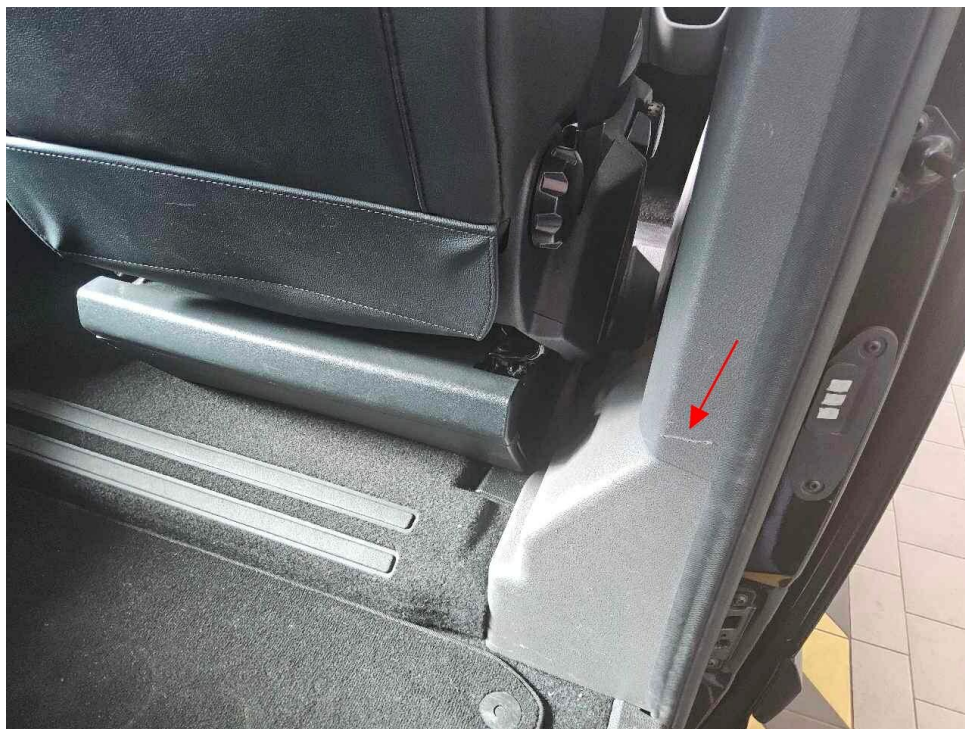
Bild 15 : Verkleidung B-Säule rechts verschrammt
