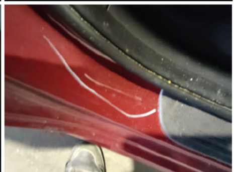
Türeinstieg / Hinten Rechts / Delle
