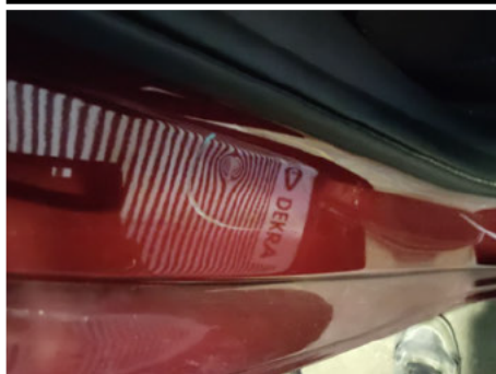
Türeinstieg / Hinten Rechts / Delle
