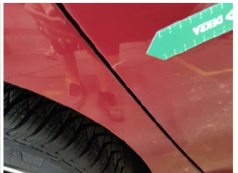
Tür / Hinten Rechts / Kratzer
