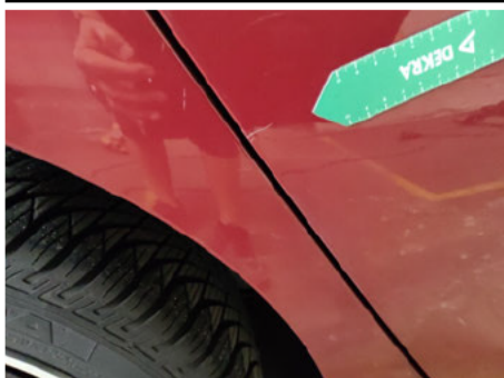
Tür / Hinten Rechts / Kratzer
