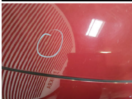
Motorhaube / Vorne / Delle
