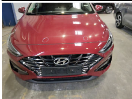
Motorhaube / Vorne / Delle
