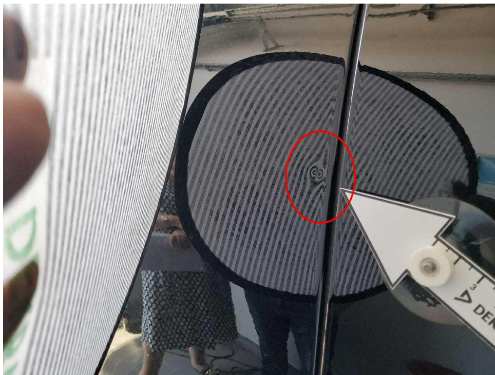
Bild 13 : Tür rechts hinten eingedellt, drücken
