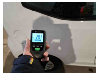
Lackstärke Seitenwand hinten rechts
