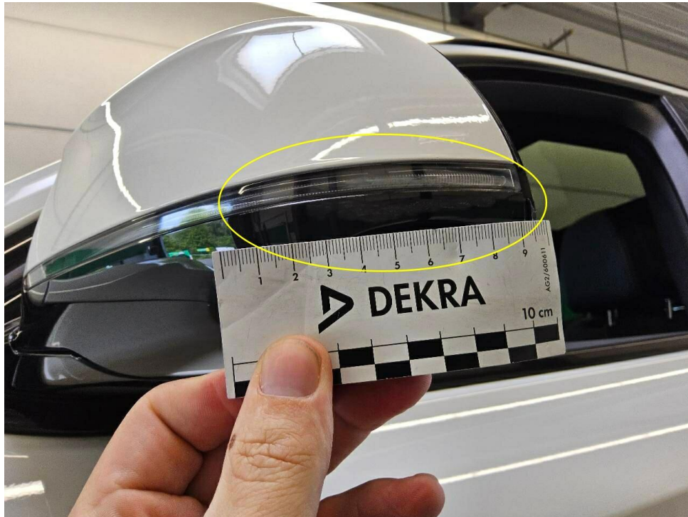
Bild 13 : Spiegel und Spiegelblinker links verschrammt
