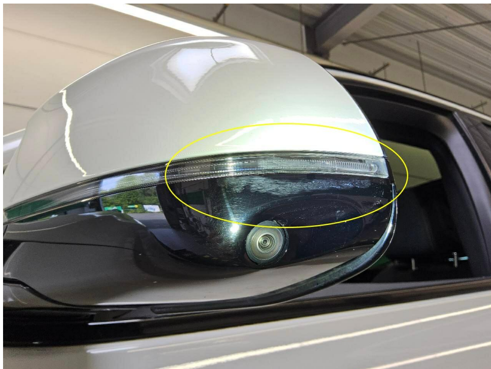
Bild 14 : Spiegel und Spiegelblinker links verschrammt
