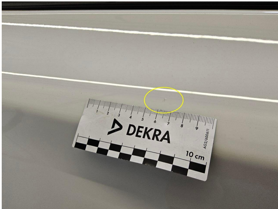
Bild 15 : Restspuren Reparaturlackierung Tür hinten rechts
