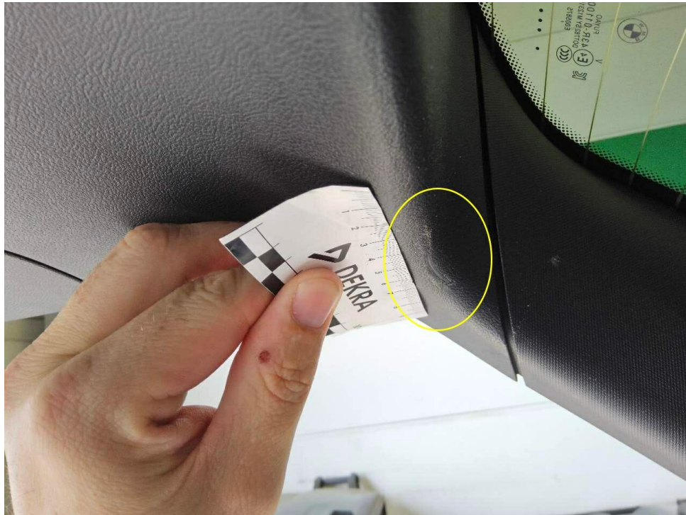
Bild 19 : Verkleidung Heckklappe verschrammt
