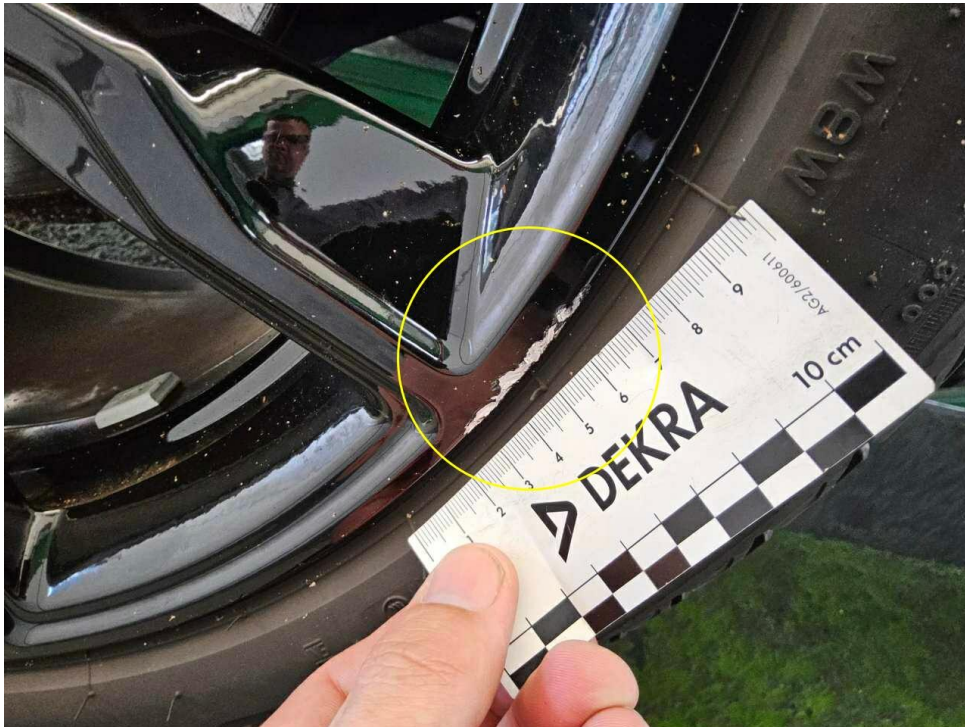
Bild 17 : Felge hinten rechts Lackierung, verschrammt, lackieren
