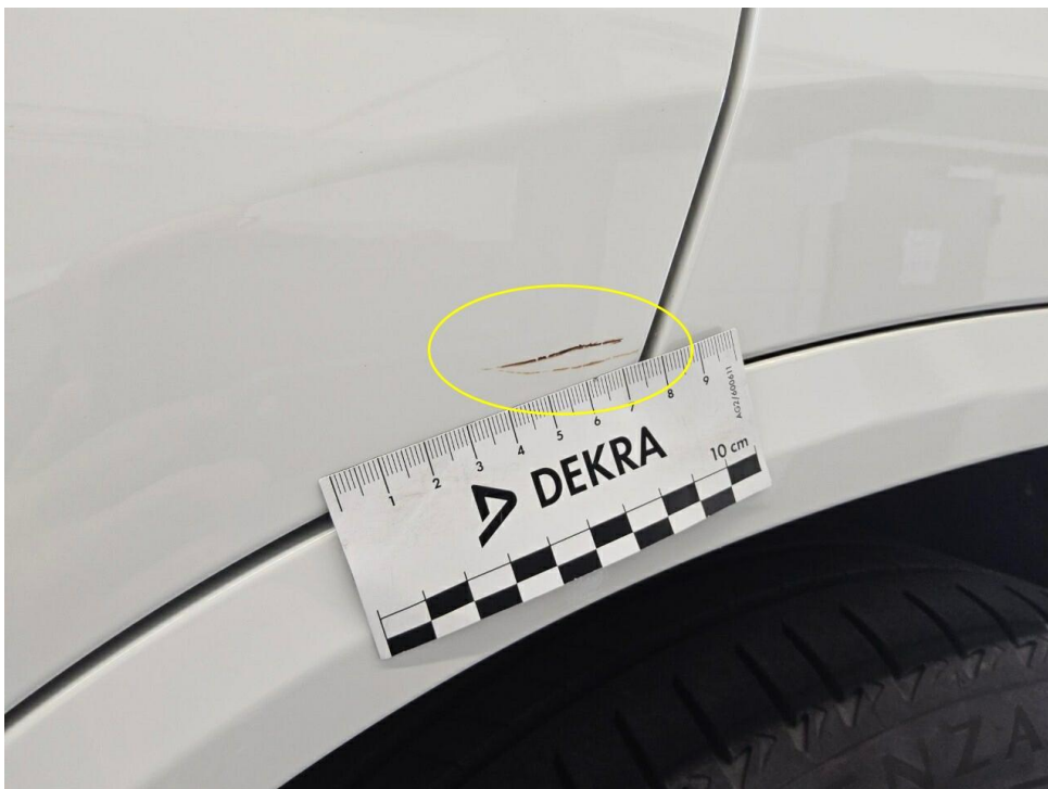
Bild 18 : Tür hinten links Lackierung, verschrammt, lackieren
