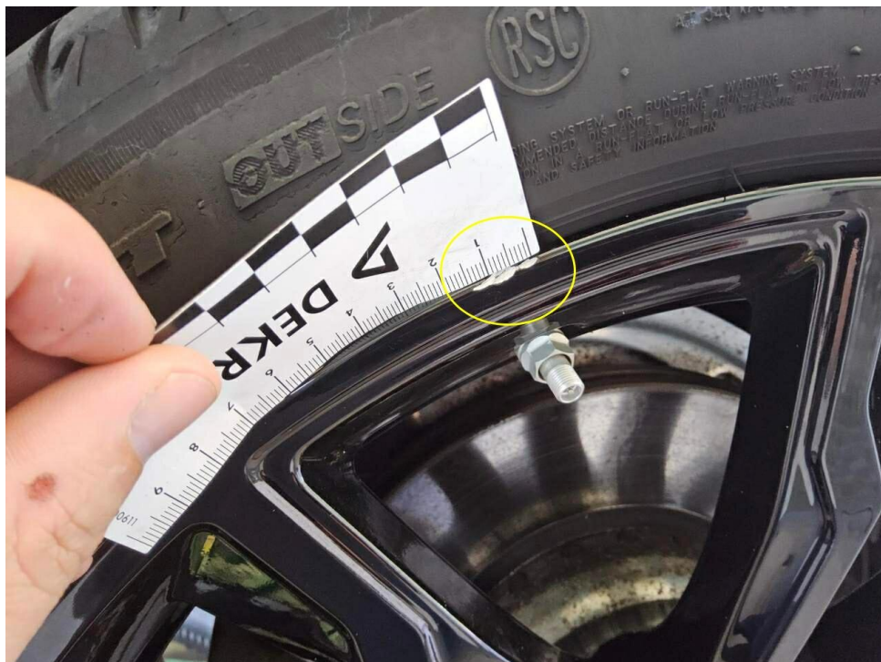
Bild 20 : Felge vorne rechts Lackierung, verschrammt, Gebrauchsspur
